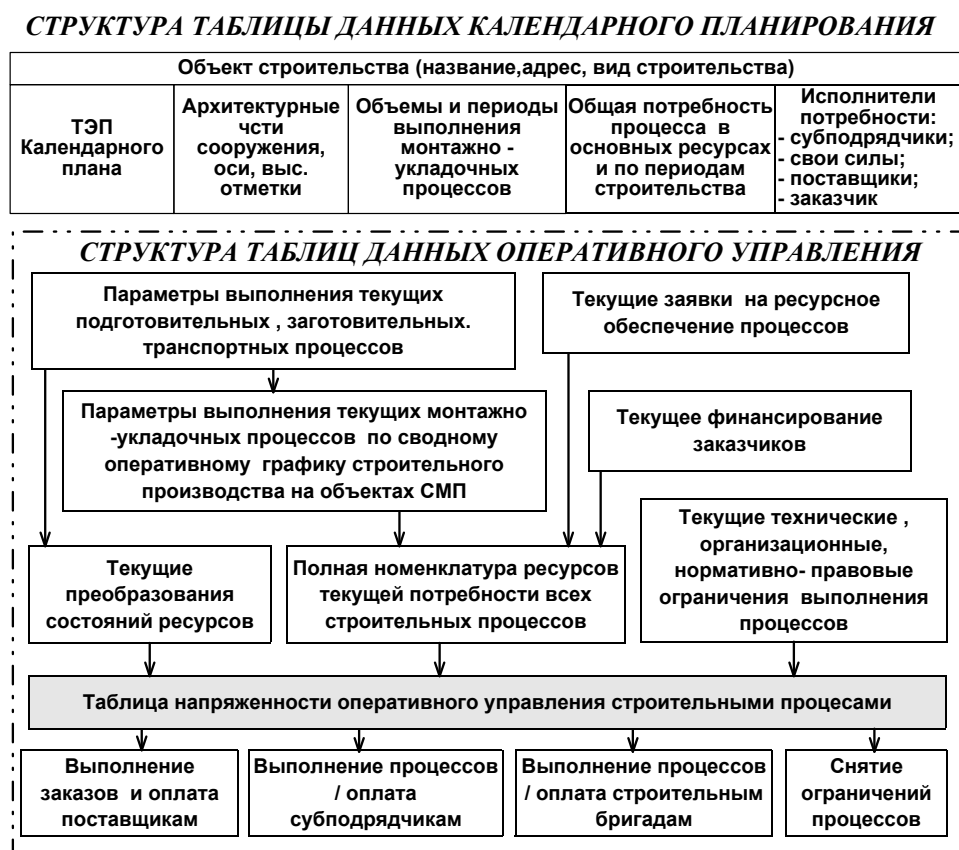
Рис. 3. Схема различия структур данных экономического, календарного планирования/учета выполнения СМР с данными оперативного управления строительными процессами
