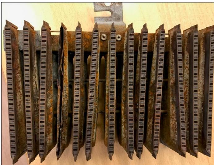
Рисунок 1.11 – Прогоревшая горелка итальянского производства «Polidoro»
