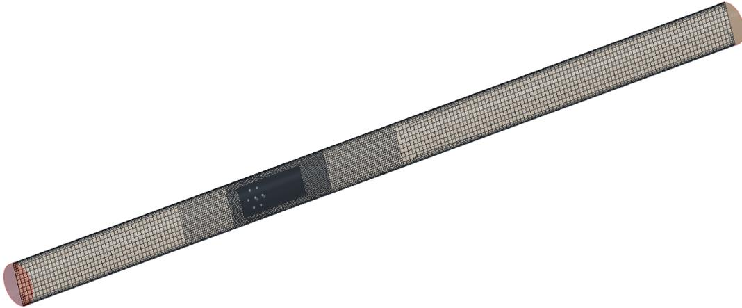
Рисунок 3.1 – Расчетная сетка в объеме трубы
