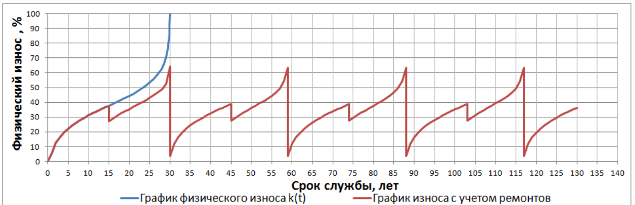
Рисунок Е.9 График износа системы отопления при периодичности проведения текущих ремонтов 15 лет
