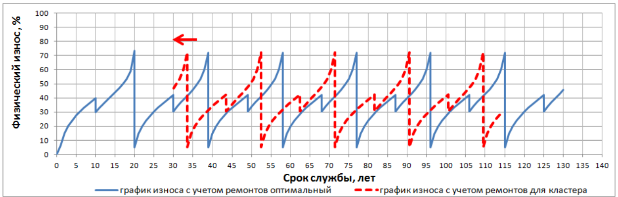
Рисунок Ж.13 График износа системы электроснабжения с учетом ремонтов для кластера К 4-1
