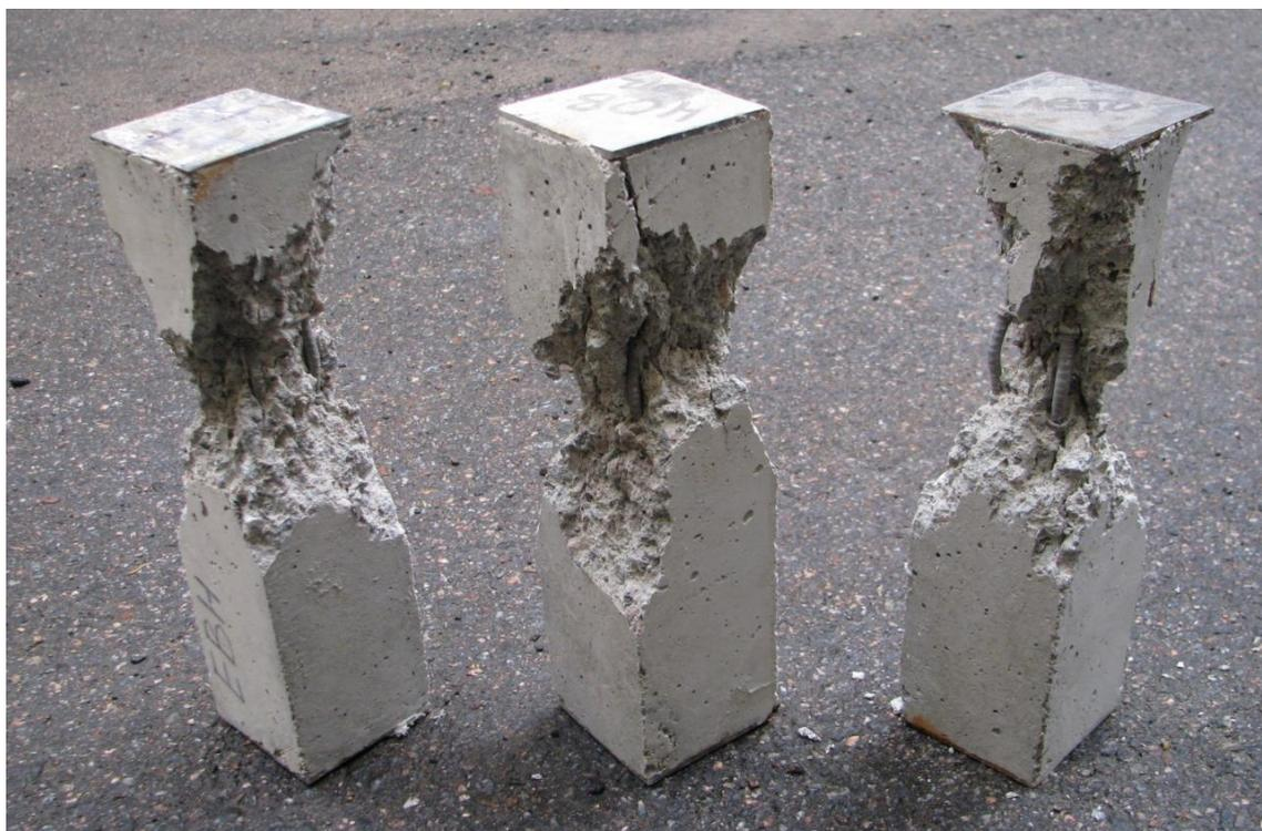
Рис. 3.6.3. Характер разрушения железобетонных призм высотой 280 мм
