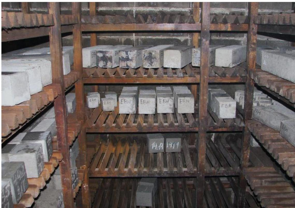
Рис. 3.5.2. Твердение кубов и призм в камере с нормальными условиями
