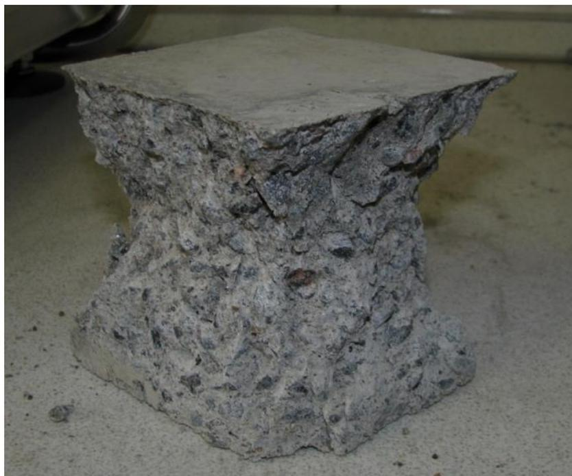
Рис. 3.6.2. Характер разрушения образца-куба длиной ребра 100 мм
