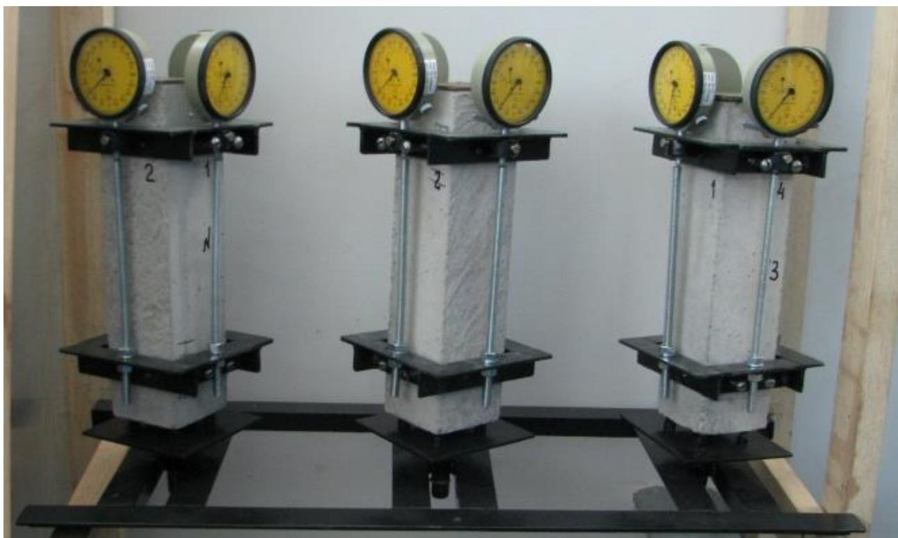
Рис. 3.6.4. Определение деформаций усадки на призмах  $100 \times 100 \times 400$  мм (а) и  $70 \times 70 \times 280$  мм (б)
