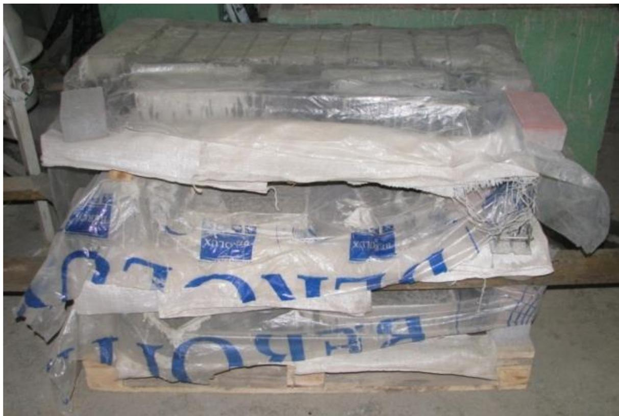
Рис. 3.5.1. Хранение образцов в формах, покрытых полиэтиленовой пленкой, в помещении цеха первые сутки до распалубки
