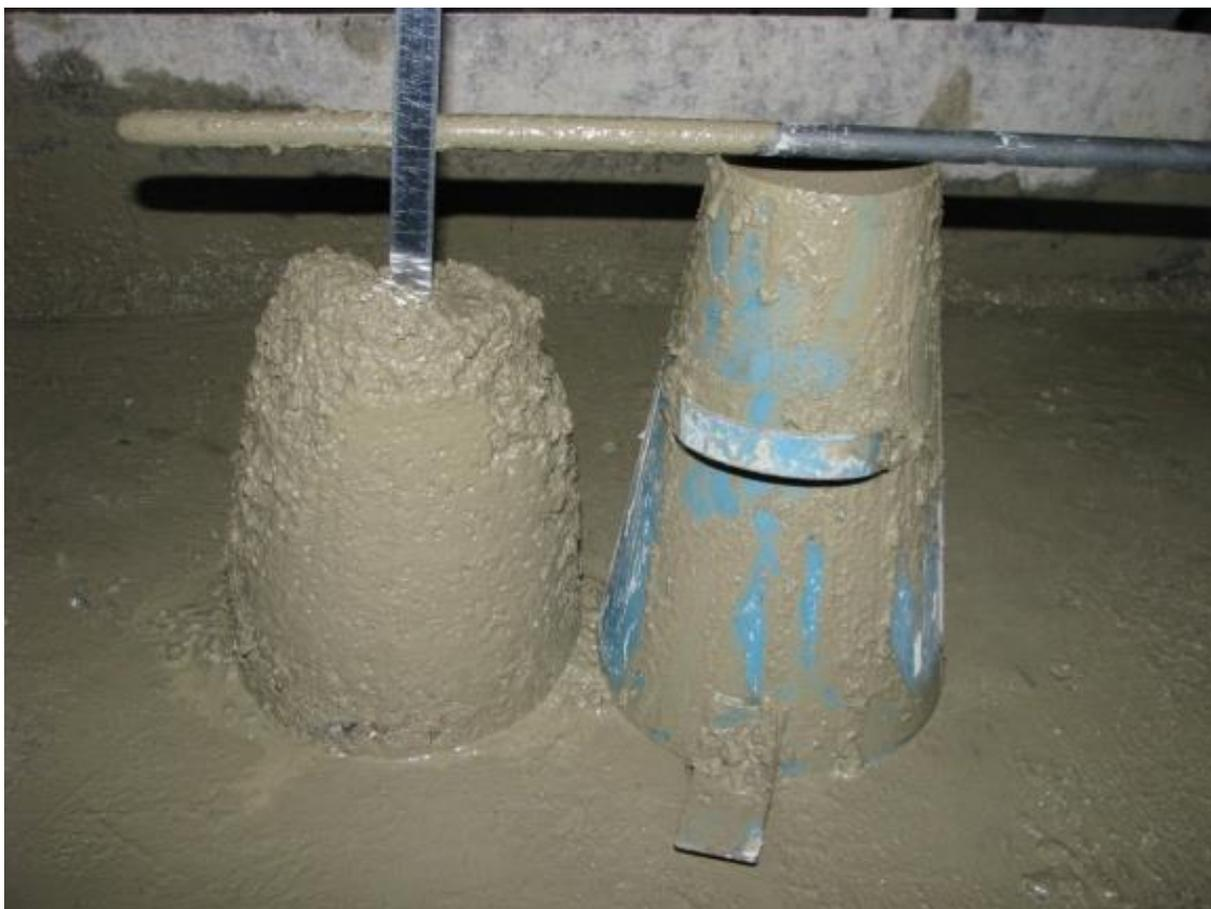
Рис. 3.4.2. Определения осадки конуса бетонной смеси
