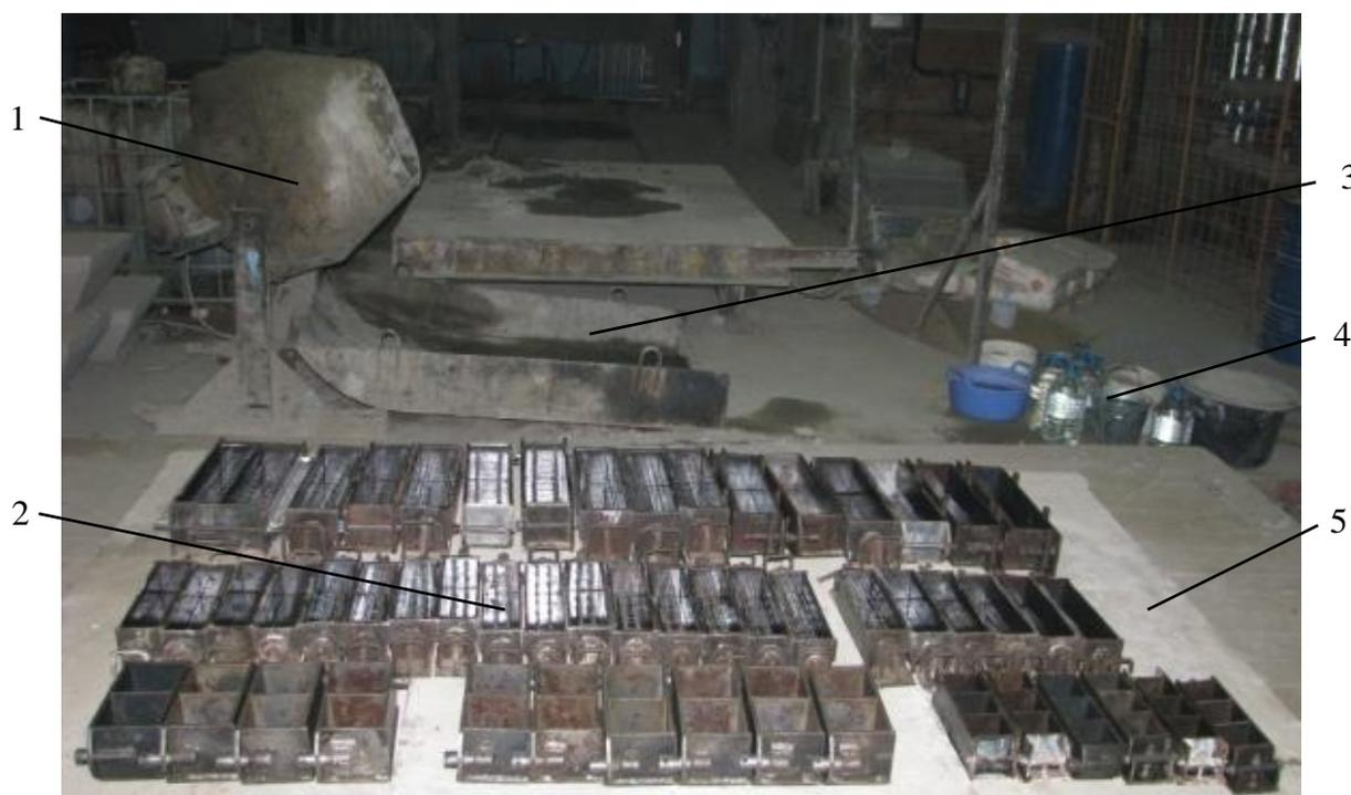
Рис. 3.4.1. Общий вид рабочего места по приготовлению бетонной смеси для изготовления образцов: 1 – гравитационный смеситель; 2 – формы; 3 – поддон; 4 – исходные материалы; 5 – производственный вибростол
