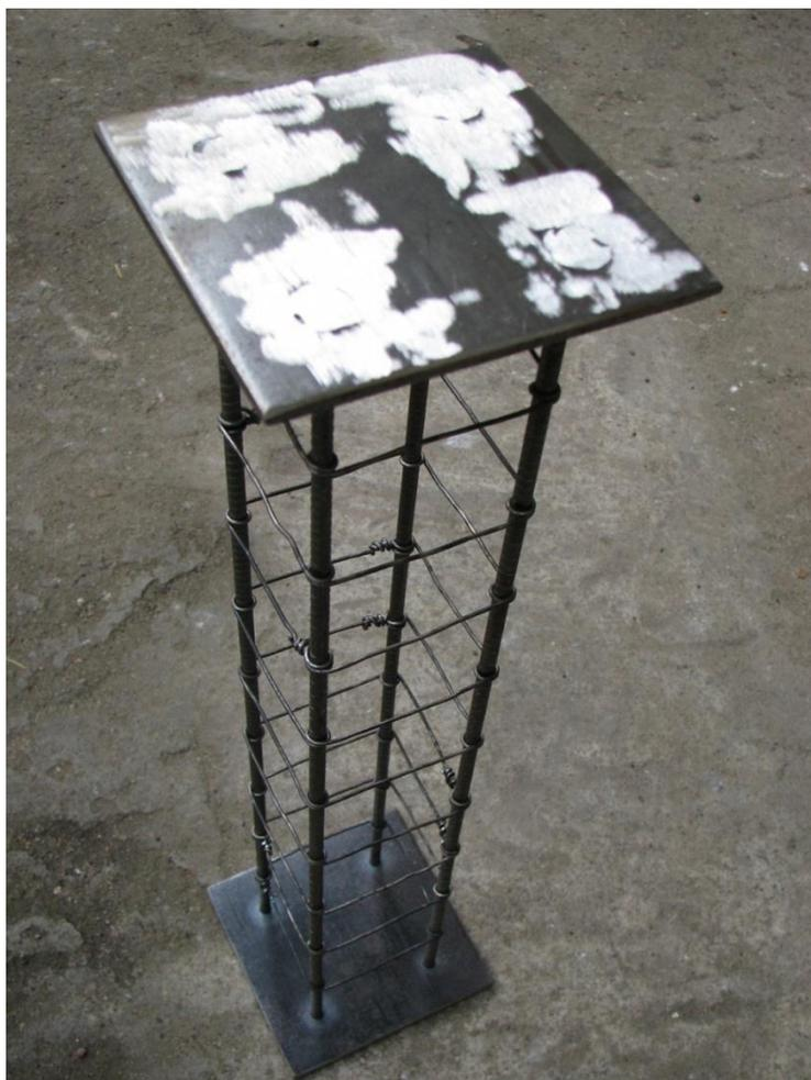
Рис. 3.3.1. Пространственный каркас для армирования призм высотой 400 мм
