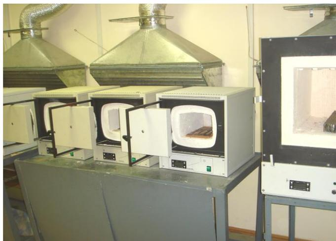
Рис. 30. Программируемые муфельные печи с микропроцессорным управлением СНОЛ 8.2/1100 и 30/1100
