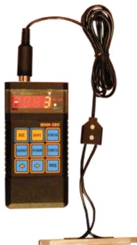
Рис. 2. Внешний вид прибора ИКНМ-2ФП
