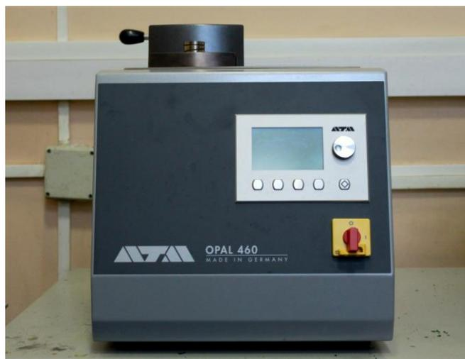
Рис. 18. Установка для запрессовки Opal 460
