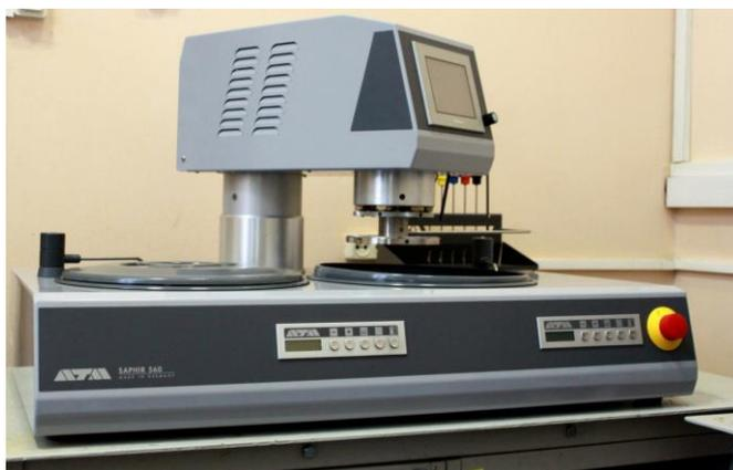
Рис. 19. Установка для шлифовки и полировки Saphir 560
