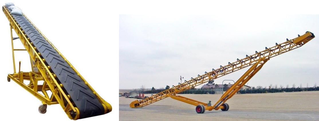
Рис. 7. Передвижные ленточные конвейеры
