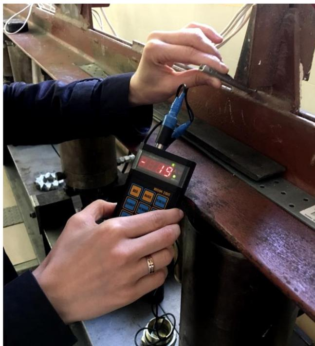
Рис. 23. Внешний вид прибора ИКНМ-2ФП с двухканальным феррозондовым преобразователем при исследовании сварного соединения
