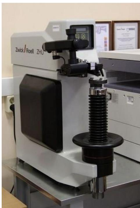
Рис. 16. Универсальный твердомер фирмы Zwick/Roel
