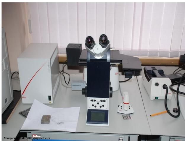
Рис. 21. Микроскоп Leica DMI5000
