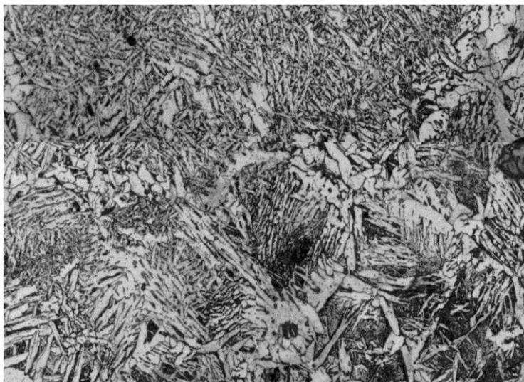
Рис. 40. Микроструктура стыкового сварного соединения из стали Ст3в зоне сплавления с участком перегрева, х200
