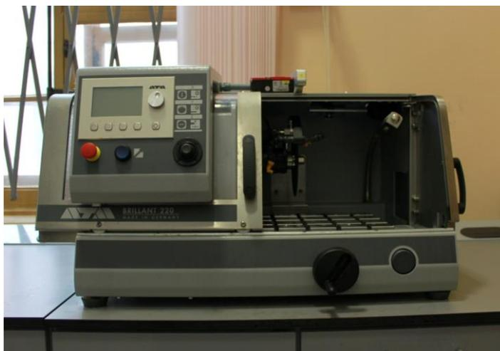
Рис. 17. Установка точной резки Brilliant 220
