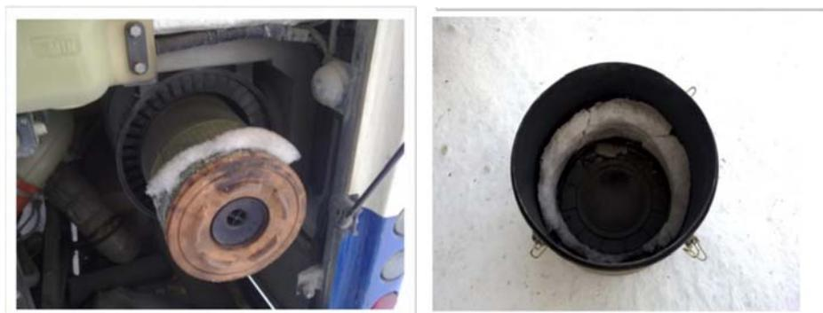
Рисунок 4 – Образование ледяной корки в защитном кожухе \ пневмобаллона KAROSA C-934
