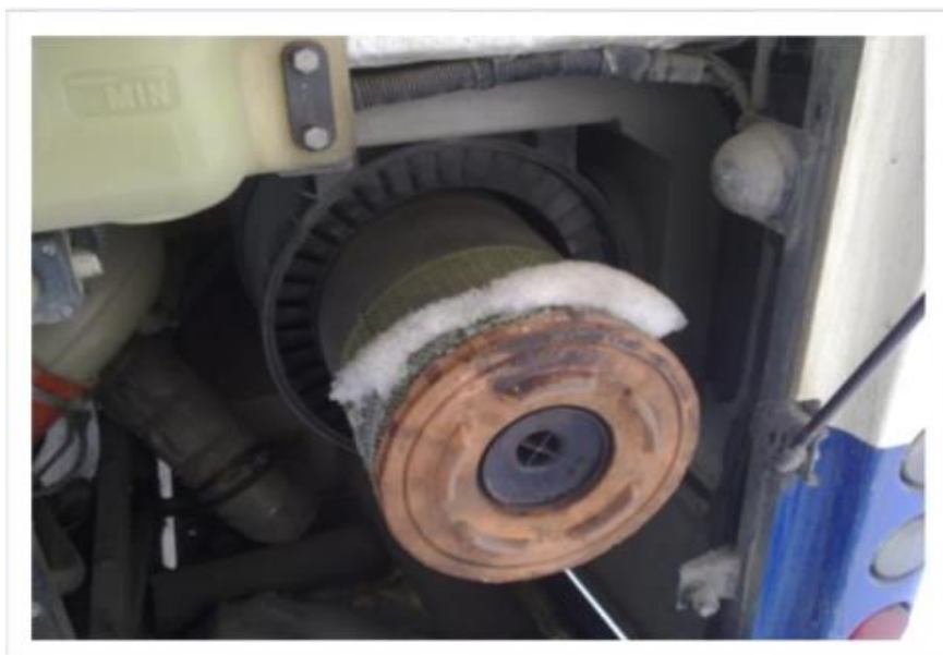
Рис.3.4. Намерзание льда на пневмобаллоне KAROSA C-934
