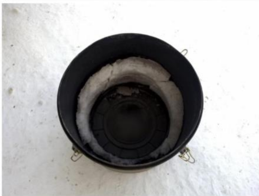
Рис.3.5. Образование ледяной корки в защитном кожухе пневмобаллона KAROSA C-934
