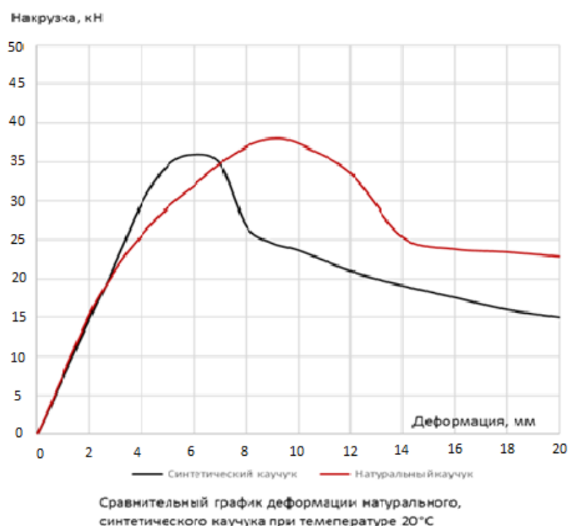
Рис. 3.14. Сравнительный график деформации пневмобаллонов при температуре 20 °C
