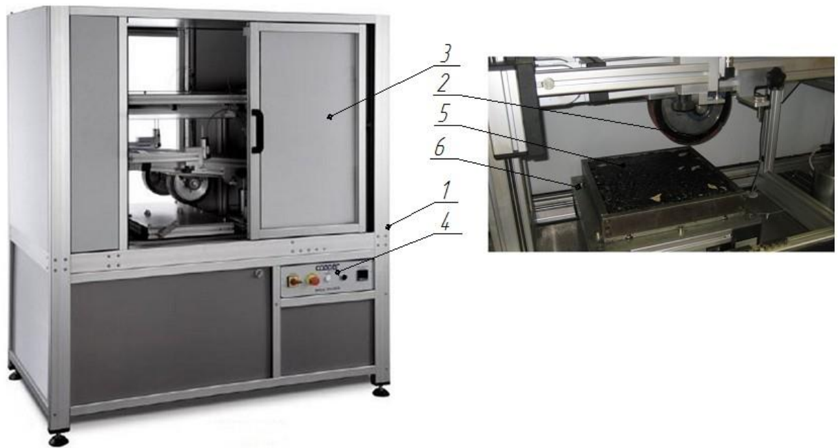
Рисунок 34– Установка для проведения испытаний на колееобразование.
