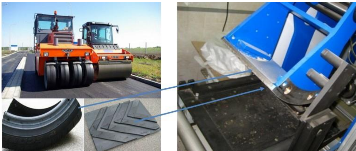
Рисунок 57– Настройки на роликовый уплотнитель для экспериментальной проверки новых рабочих органов с изотропным силовым воздействием.
