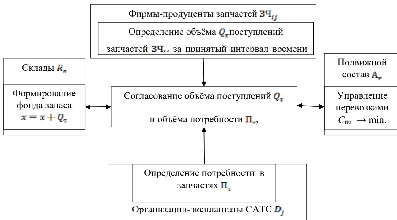
Рисунок 2.1 – Структура ИТЛС в функциях, реализуемых в процессах поставки запчастей
