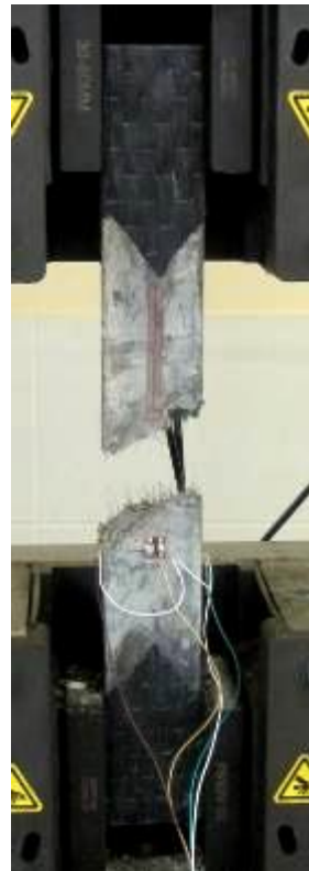
Рисунок 2.12 – Вид фибробетонных призм после разрушения а) при \mu=1,5\% ; б) при \mu=2,0\%
