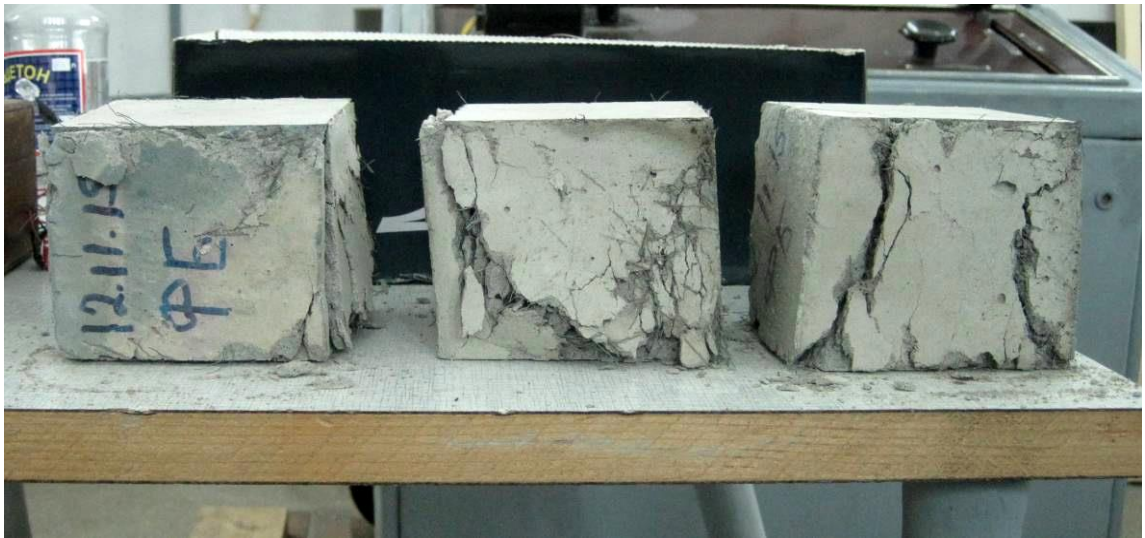
Рисунок 2.3 – Фибробетонные кубы после испытания на сжатие
