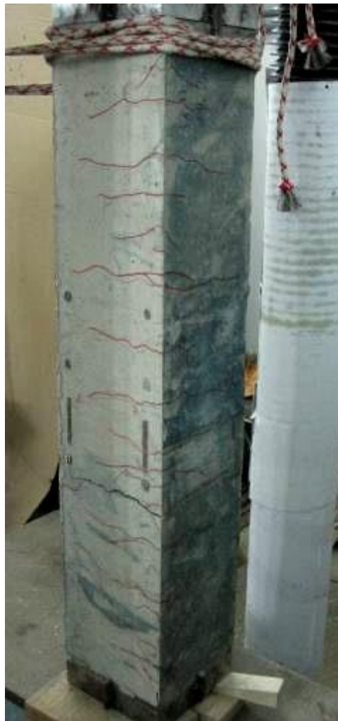
Рисунок 3.12 – Вид разрушенной фиброжелезобетонной стойки, e_x = 4 см, e_y = 5 см а) сжатая зона; б) растянутая зона
