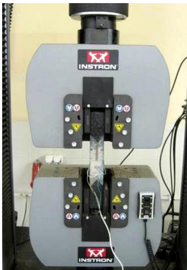
Рисунок 2.9 – Общий вид образца при испытании на прессе INSTRON 600
