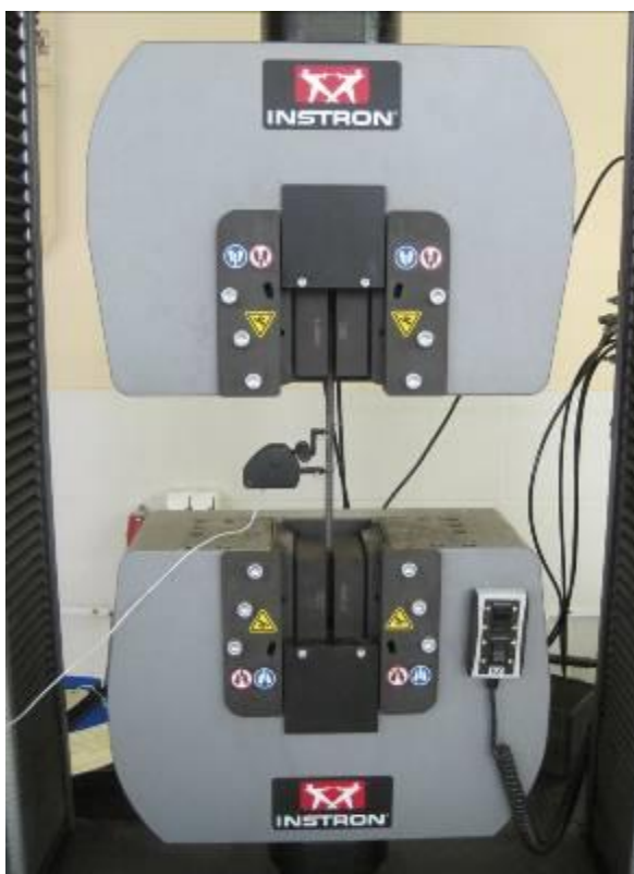
Рисунок 2.18 – Общий вид арматурного стержня при испытании на растяжение
