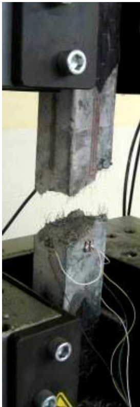
Рисунок 2.12 – Вид фибробетонных призм после разрушения а) при \mu=1,5\% ; б) при \mu=2,0\%
