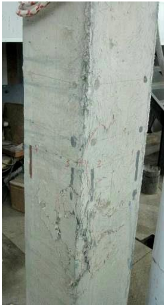
Рисунок 3.12 – Вид разрушенной фиброжелезобетонной стойки, e_x = 4 см, e_y = 5 см а) сжатая зона; б) растянутая зона
