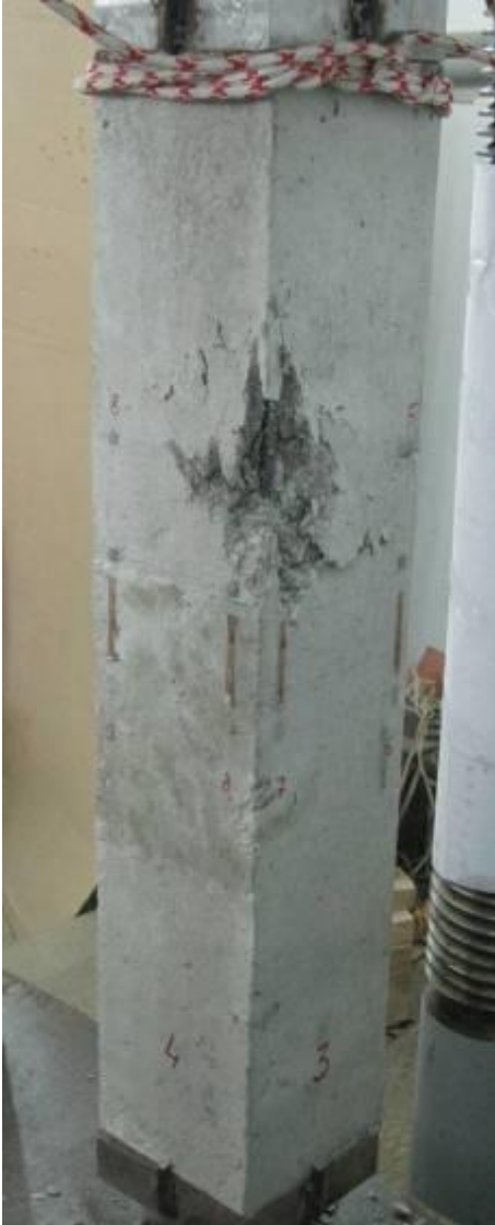
Рисунок 3.9 – Вид разрушенной железобетонной стойки, e_x = 3 см, e_y = 6 см а) сжатая зона; б) растянутая зона
