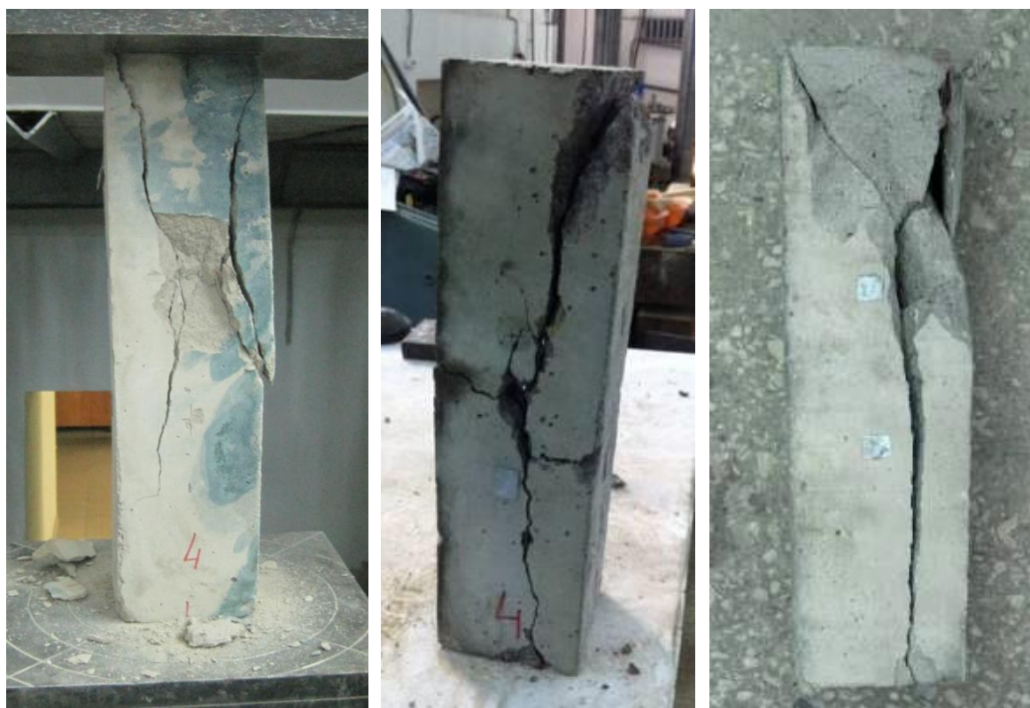
Рисунок 2.5 – Бетонные призмы после испытания на сжатие
