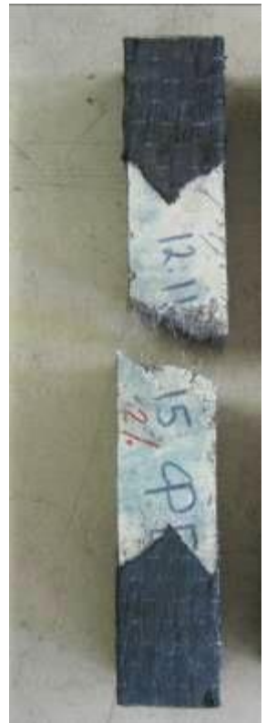
Рисунок 2.12 – Вид фибробетонных призм после разрушения а) при \mu=1,5\% ; б) при \mu=2,0\%
