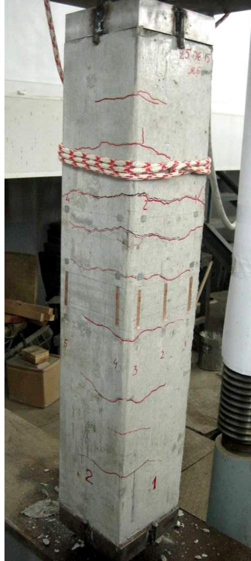
Рисунок 3.9 – Вид разрушенной железобетонной стойки, e_x = 3 см, e_y = 6 см а) сжатая зона; б) растянутая зона
