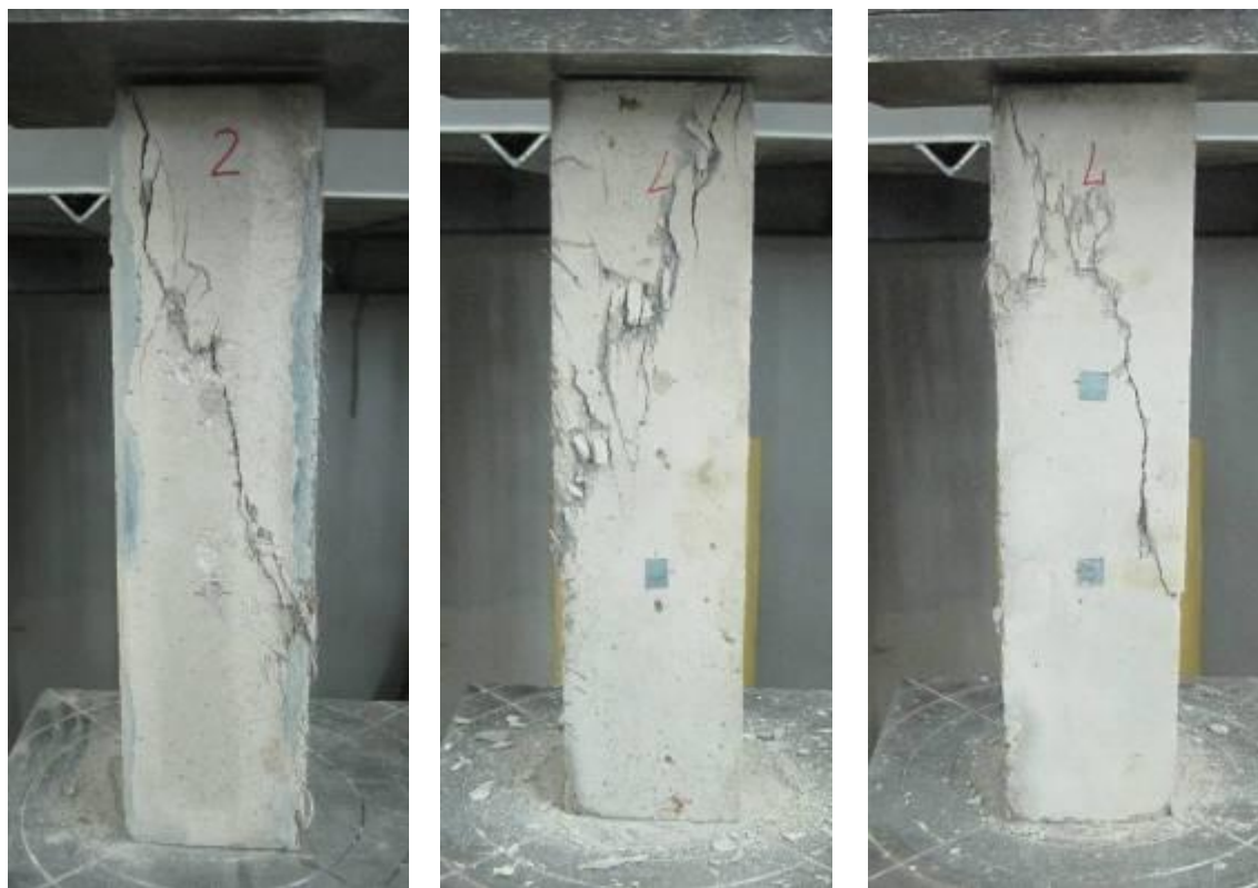
Рисунок 2.6 – Фибробетонные призмы после испытания на сжатие с \mu=2,0\% .
