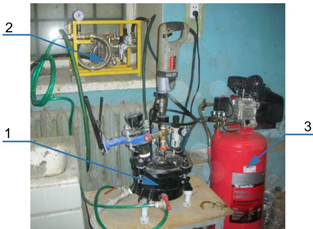
Рисунок 5 – Лабораторная установка для приготовления фибропенобетонной смеси
