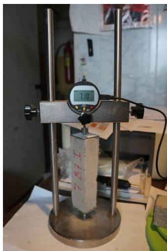
Рисунок 8 - Прибор для измерения усадки
