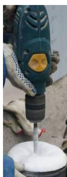
Рисунок 6 - Дрель со вспенивающей насадкой
