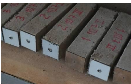
Рисунок 10 - Образцы-балочки со стальными реперами
