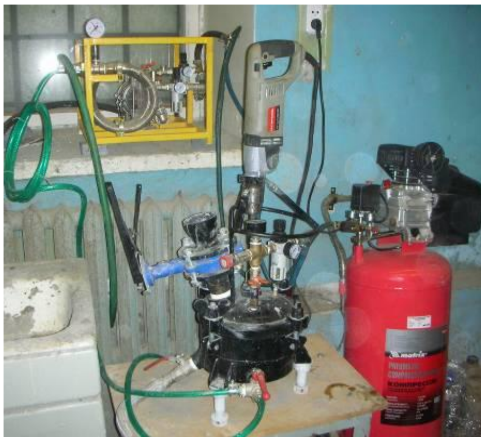
Рисунок 3 - Лабораторная установка для приготовления фибропенобетонной смеси
