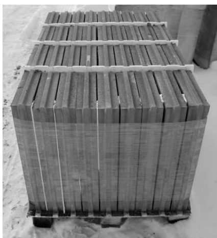
Рисунок 44 - Поддон с пазогребневыми плитами из фибропенобетона
