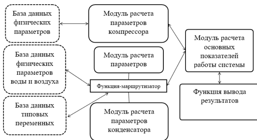
Рисунок 1 – Структура ядра программы расчета и моделирования параметров работы системы утилизации на основе ВТН
