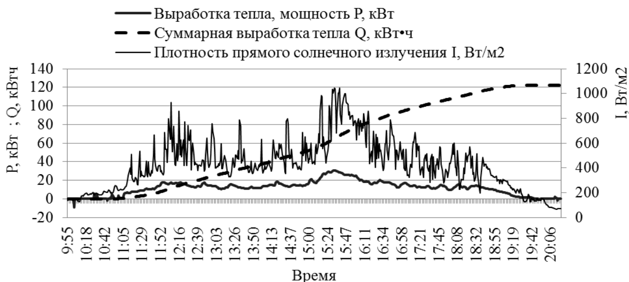
Рисунок 3.19 – График изменения рабочих параметров СВНУ для 29.06.2012. Плотность прямого солнечного излучения, мощность и суммарная выработка тепла
