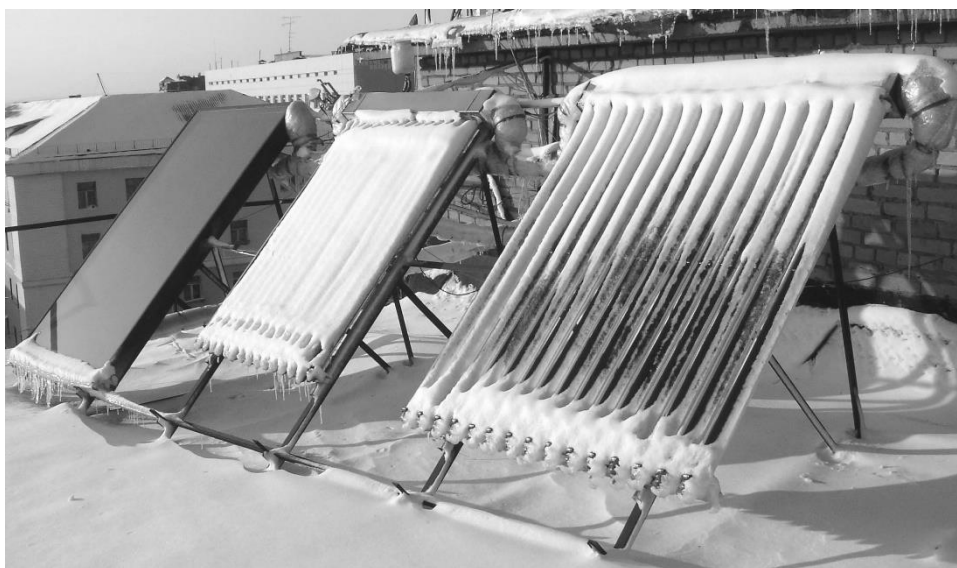
Рисунок 2.2 – Испытание разных типов коллекторов (плоского и вакуумных трубчатых) на стенде лаборатории нетрадиционной энергетики ИПМТ ДВО РАН. Самоочищение от снега [95]
