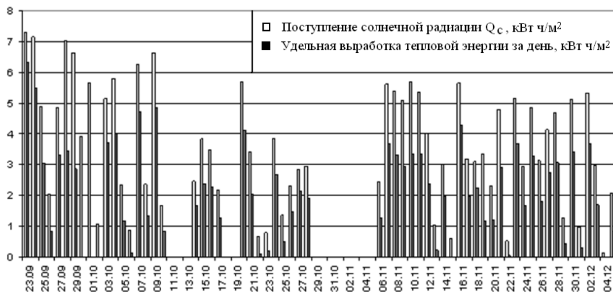
Рисунок 2.6 – Диаграмма поступления солнечной радиации и удельной выработки тепловой энергии вакуумным солнечным коллектором (осенне-зимний сезон 2013 г.) [95]
