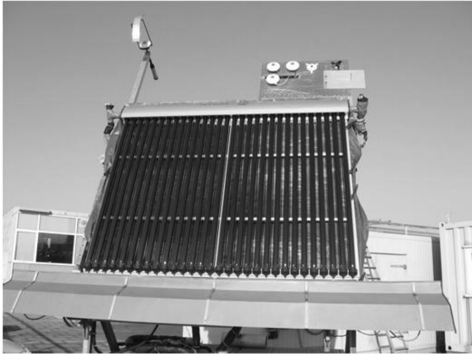
Рисунок 2.4 – Размещение вакуумного коллектора на стенде при проведении испытаний
