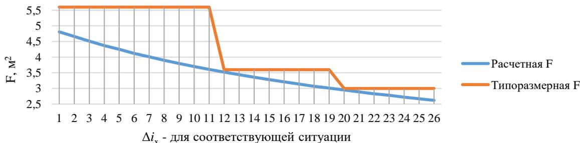
Рисунок 2.19 – Изменение значения расчетной и соответствующей ей типоразмерной площади, характерные для ситуации №2.2
