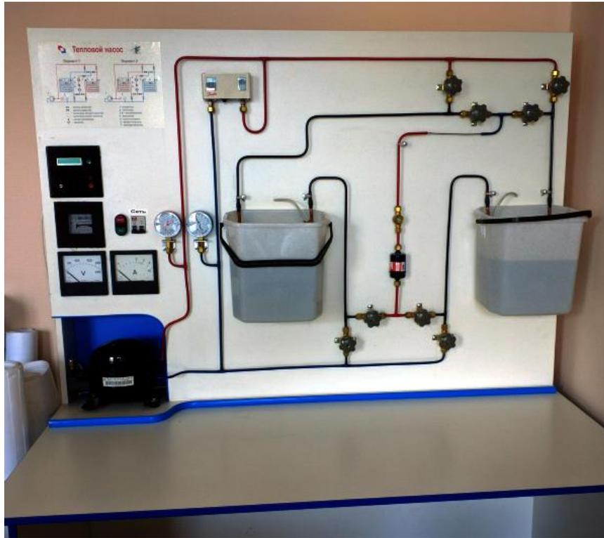
Рисунок 4.3 – Экспериментальный стенд «Тепловой насос»
