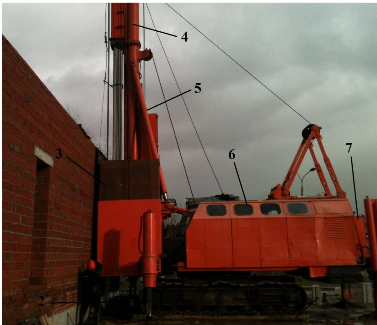
Рисунок 1.4 - Установка вдавливания СВУ-В-6:
