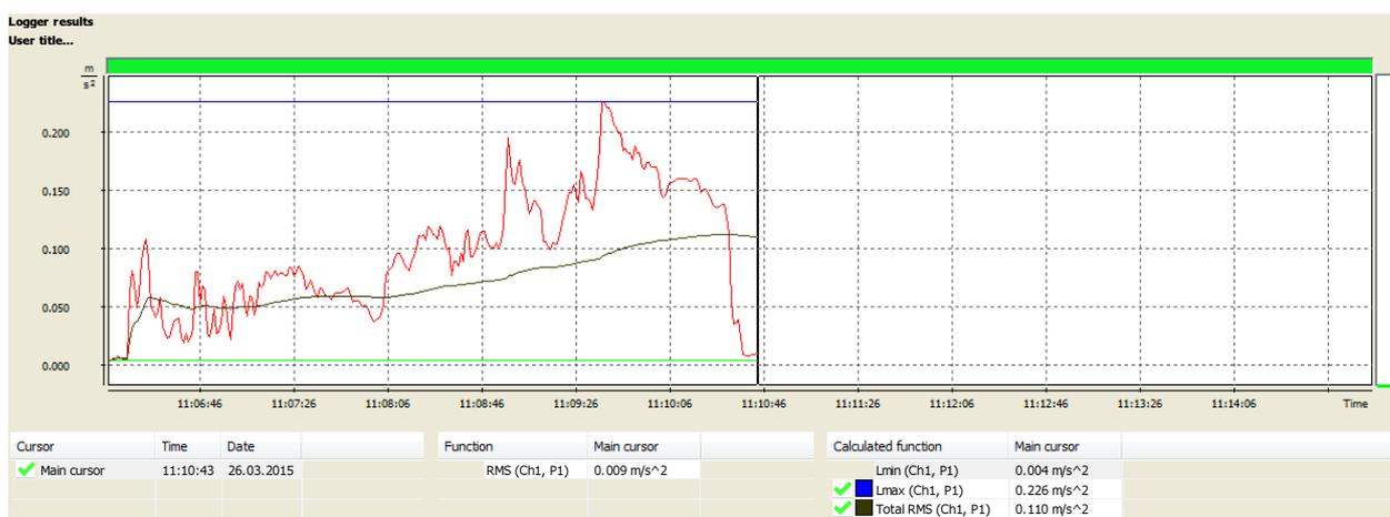
Рисунок 1.6 - График значений ускорений колебаний в процессе вибропогружения шпунта
