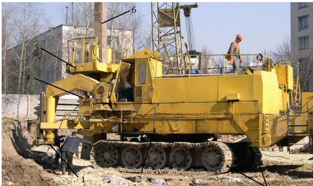
Рисунок 1.1 - Установка для вдавливания свай и шпунта УСВ-160:
