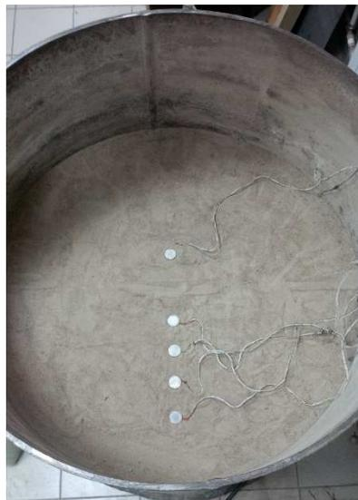
Рисунок 3.3.в - Фото закладки месдоз на глубине – 39 см
