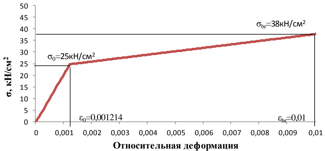
Рисунок 3.11 — Билинейная диаграмма растяжения–сжатия стали
