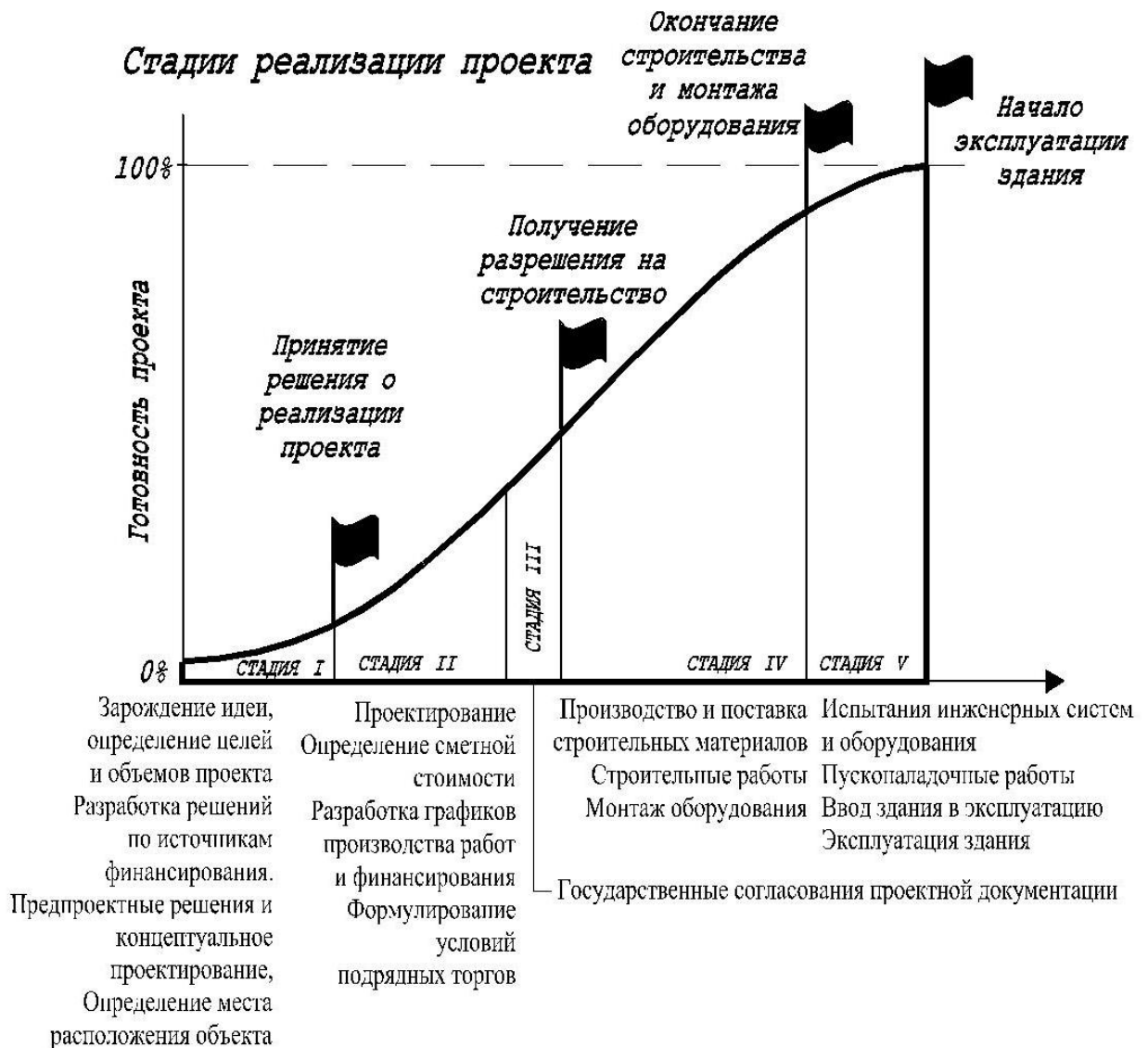
Рисунок 2.11 - Вехи жизненного цикла строительного проекта МФК
