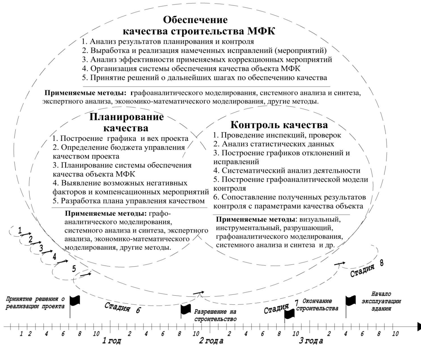
Рисунок 3.8 - Модель обеспечения качества строительства объектов МФК
