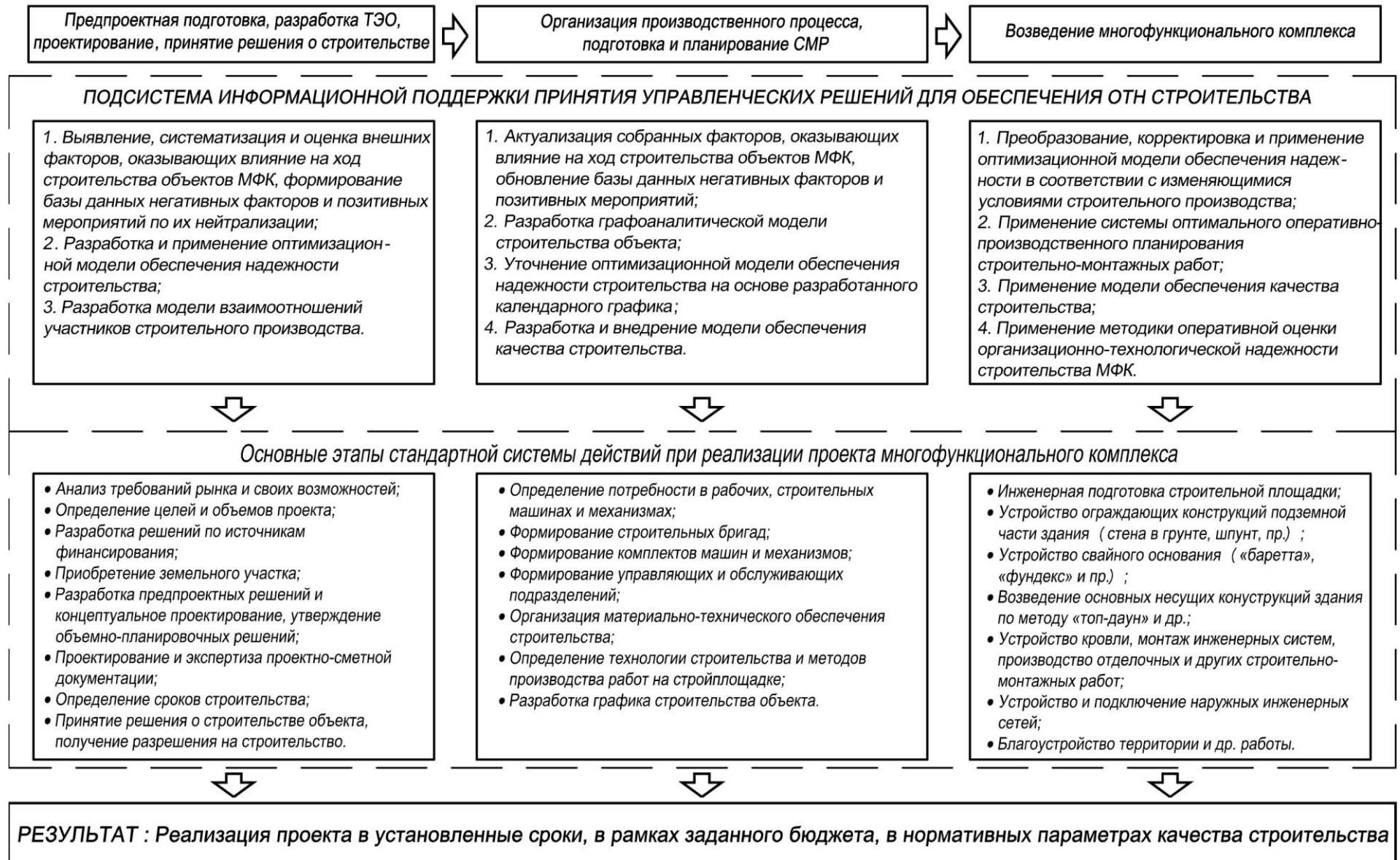
Рисунок 2.13 - Модель обеспечения организационно-технологической надежности строительства МФК
