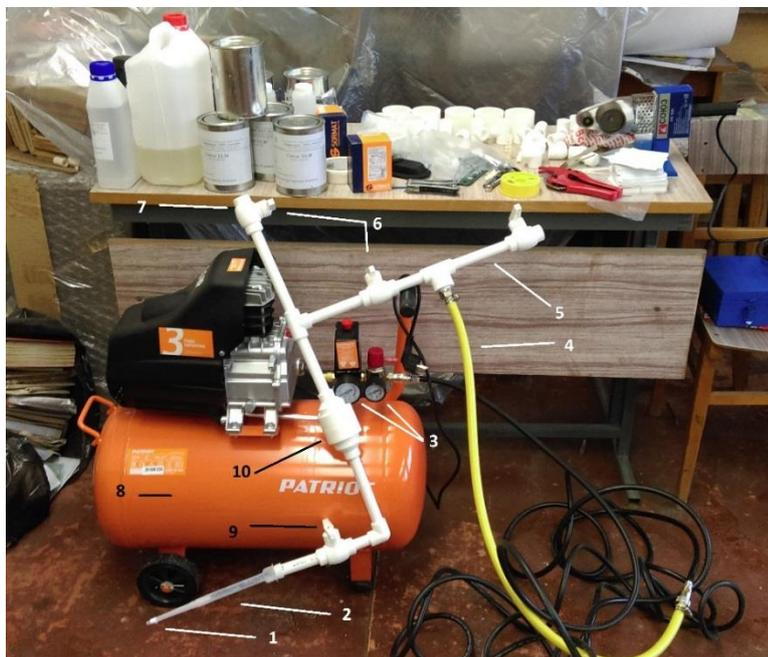
Рисунок 3 – Экспериментальный стенд для устройства анкеров методом нагнетания при устройстве в газобетонных блоках. 1 – гидроизоляция сопла (лента ФУМ); 2 – сопло (миксер *Hilti*); 3 – регулировочные манометры; 4 – полый гибкий патрубок для подачи сжатого воздуха; 5 – полимерные трубы Ø20-50мм; 6 – шаровые краны; 7 – загрузочное отверстие; 8 – ресивер компрессионной установки; 9 – шаровый кран регулирования подачи клеевой композиции; 10 – емкость для размещения рабочего объема композиции
