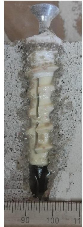
Рисунок 5 – Продольный разрез установленного анкера. Фотография выполнена до отверждения композиции
