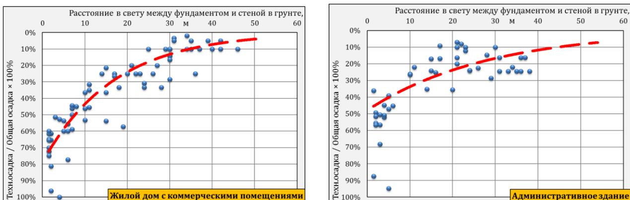
Рисунок 10 – Доля технологической осадки в общей итоговой осадке в зависимости от расстояния до стены в грунте
