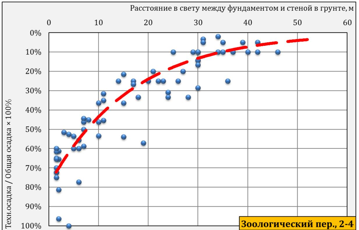
Рисунок 1.12 – Доля технологической осадки в общей итоговой осадке в зависимости от расстояния до стены в грунте
