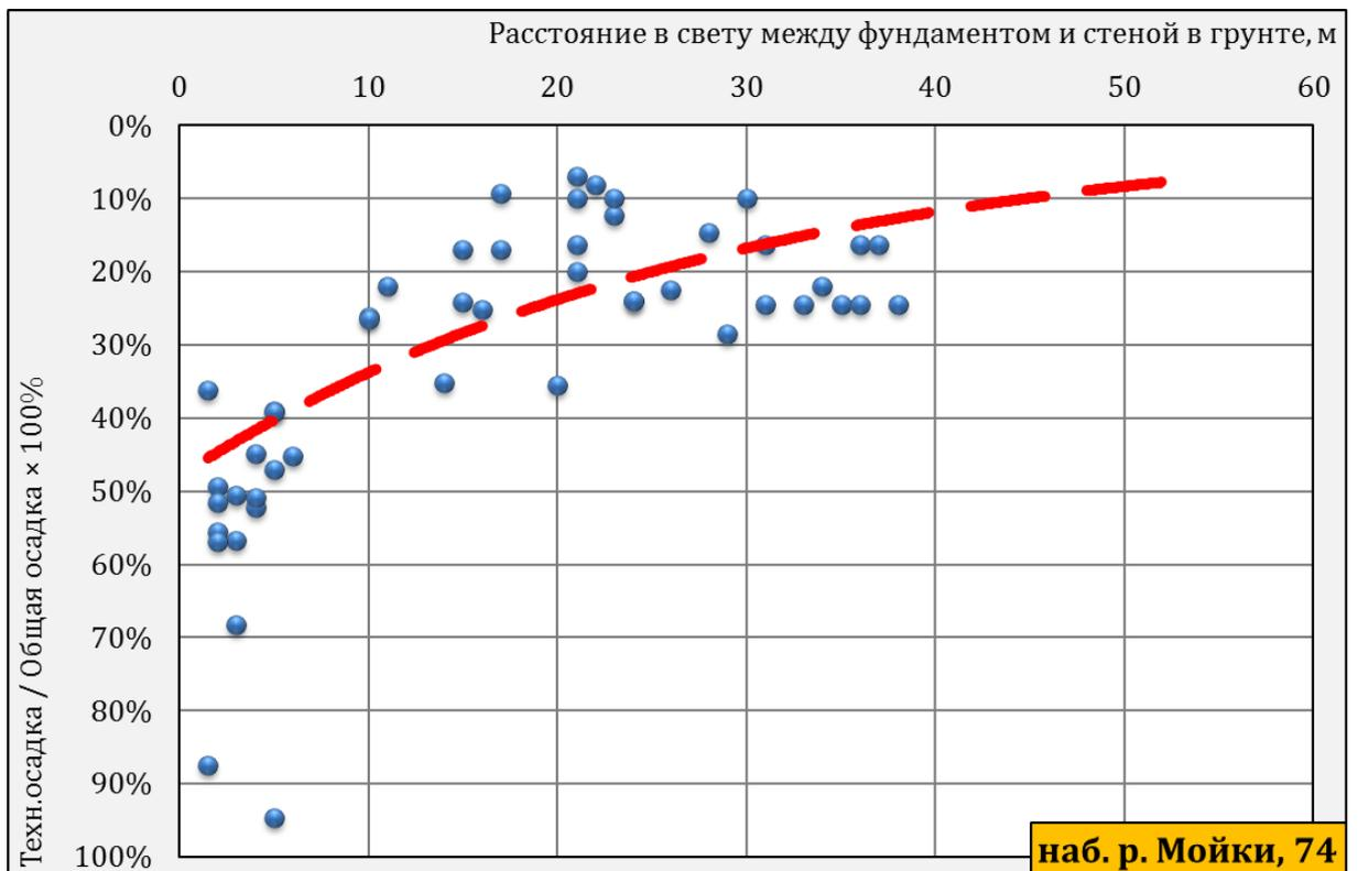
Рисунок 1.13 – Доля технологической осадки в общей итоговой осадке в зависимости от расстояния до стены в грунте
