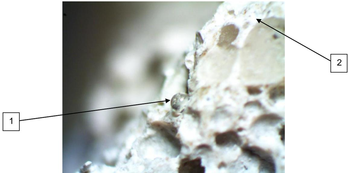
Рисунок 34 – Микрофотография граничной зоны, в которую нагнеталась клеевая композиция на основе полимочевины. 1 – клеевая композиция в виде капли; 2 – скелет газобетона
