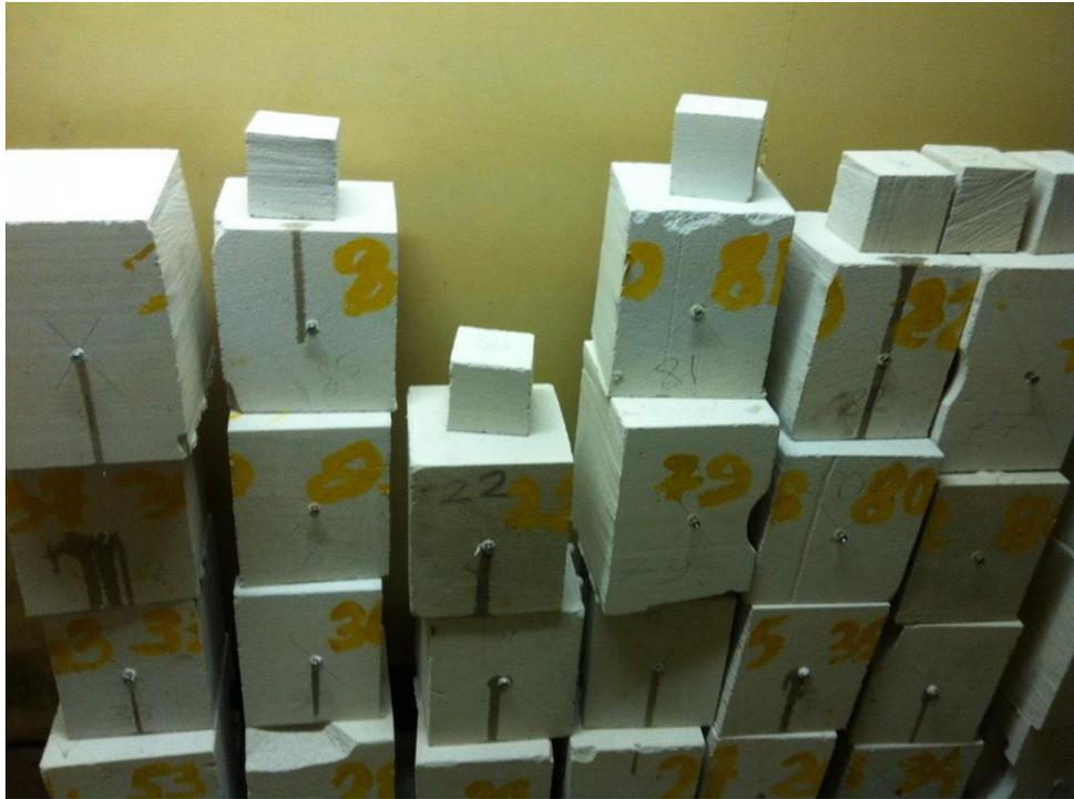
Рисунок 28 – Складирование анкерных креплений на период набора прочности
