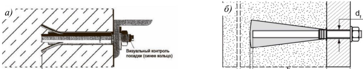
Рисунок 50 – Виды используемых дюбелей для экономического расчета: а) Вариант I – Hitli HPD, б) Вариант III – Химический анкер, устанавливаемый в конусное отверстие
