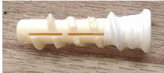
Рисунок 25 – Фотография используемого анкера. На фото видны уменьшенные промежуточные выступы спирали, углубления на теле дюбеля и уплотнительная лента ФУМ на голове дюбеля
