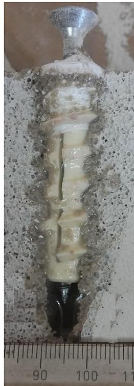
Рисунок 27 – Продольный разрез установленного анкера. Фотография выполнена до схватывания композиции
