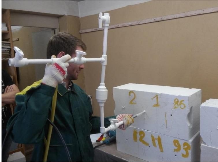
Рисунок 26 – Процесс подачи клеевой композиции через сопло нагнетательной установки в ранее установленный дюбель
