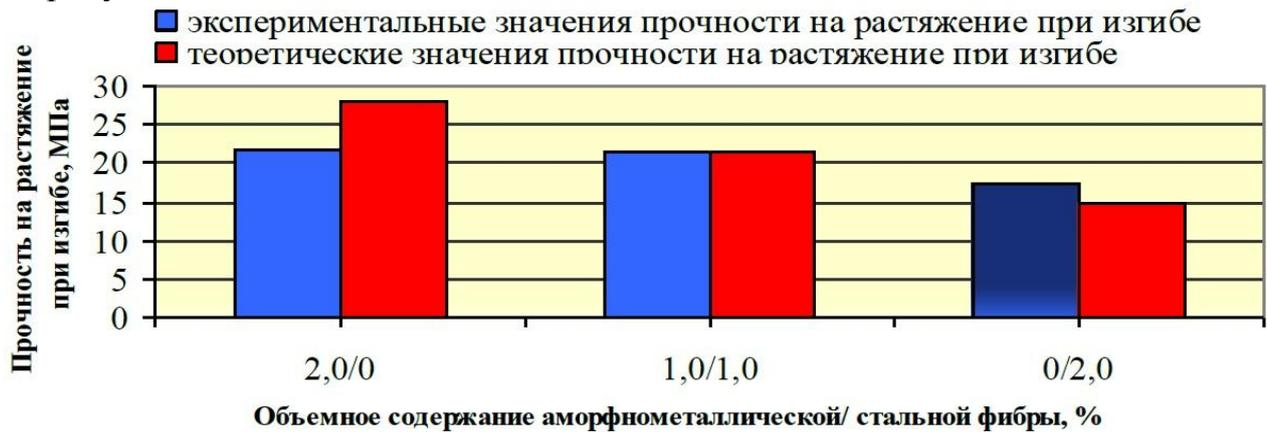
Рисунок 9 – Зависимость прочности на растяжение при изгибе от соотношения аморфнометаллической и стальной фибры
