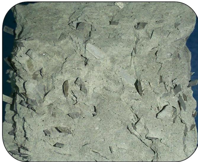
Рисунок 3 – Поверхность разрушенного фиброцементного образца, армированного аморфнометаллической фиброй
