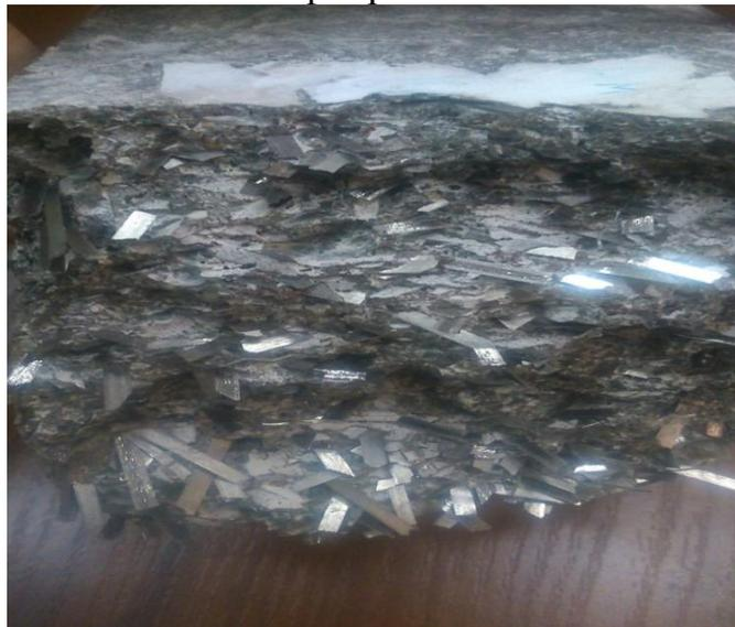
Рисунок 11 – Образец, армированный 3% аморфнометаллической фибры по объему, после испытания прочности при изгибе
