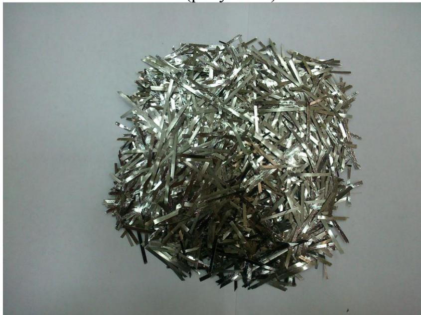
Рисунок 1 – Аморфнометаллическая фибра
