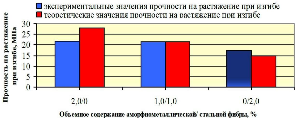
Рисунок 3.5 – Зависимость прочности на растяжение при изгибе от соотношения аморфнометаллической и стальной фибры
