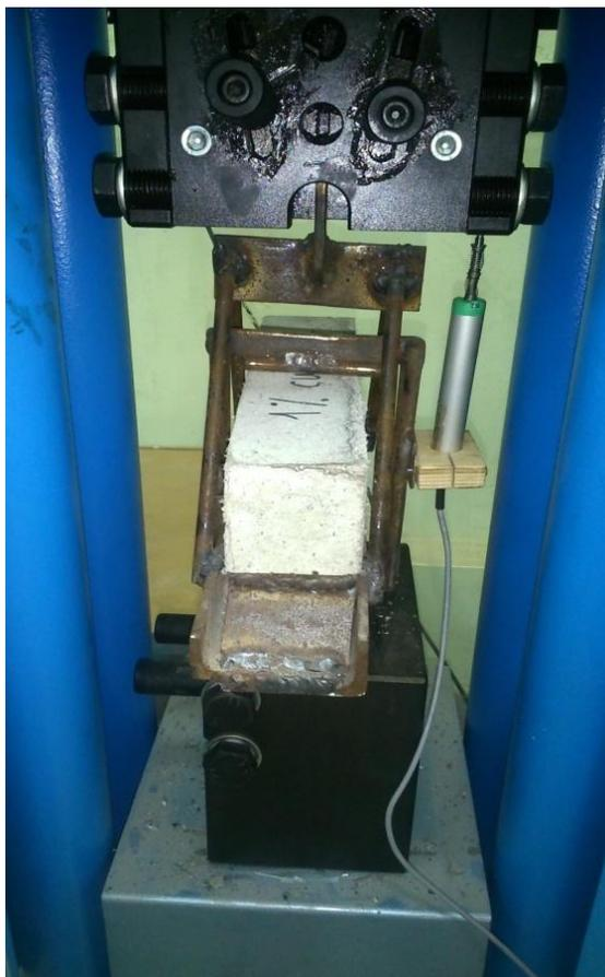
Рисунок 2.4 – Испытание фибробетонных призм для определения силовых и энергетических характеристик разрушения
