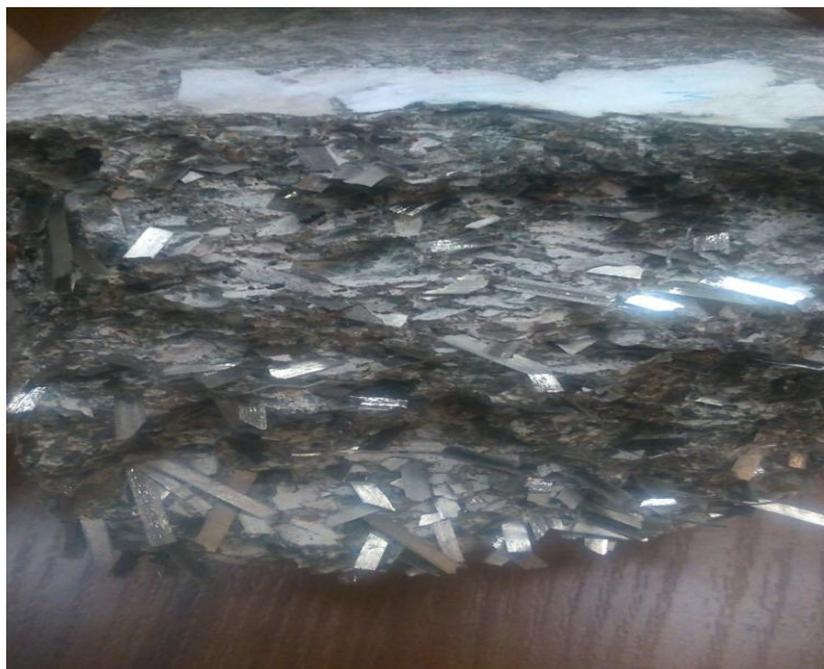
Рисунок 4.3 – Вид образца, армированного аморфнометаллической фиброй в объеме 3% после испытания на изгибе
