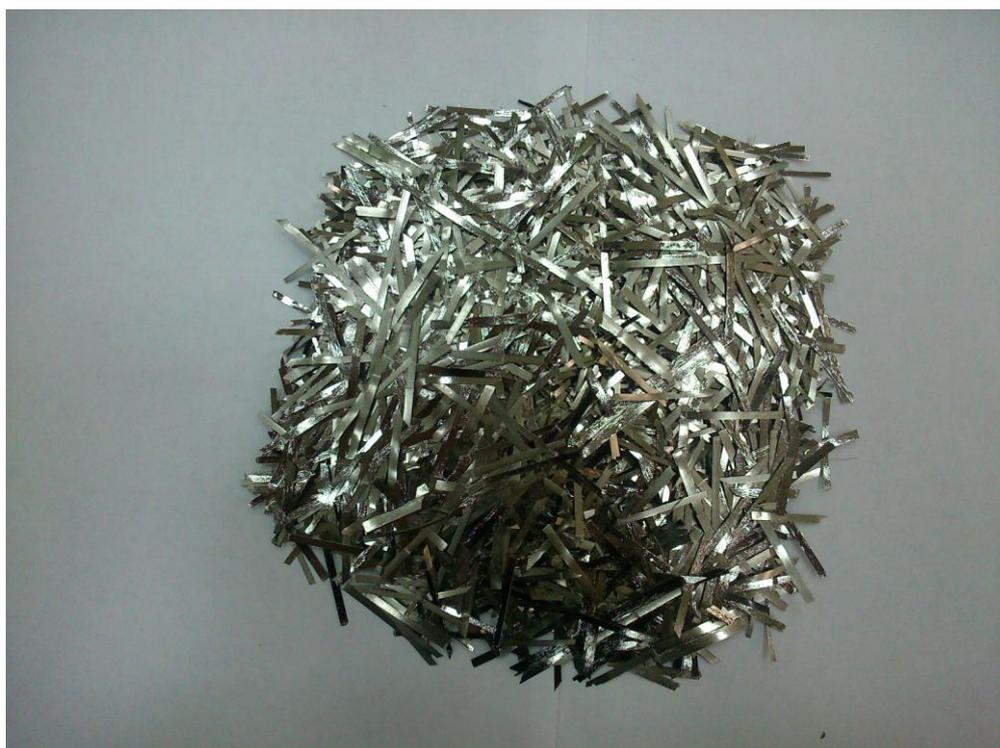
Рисунок 1.1 – Аморфнометаллическая фибра
