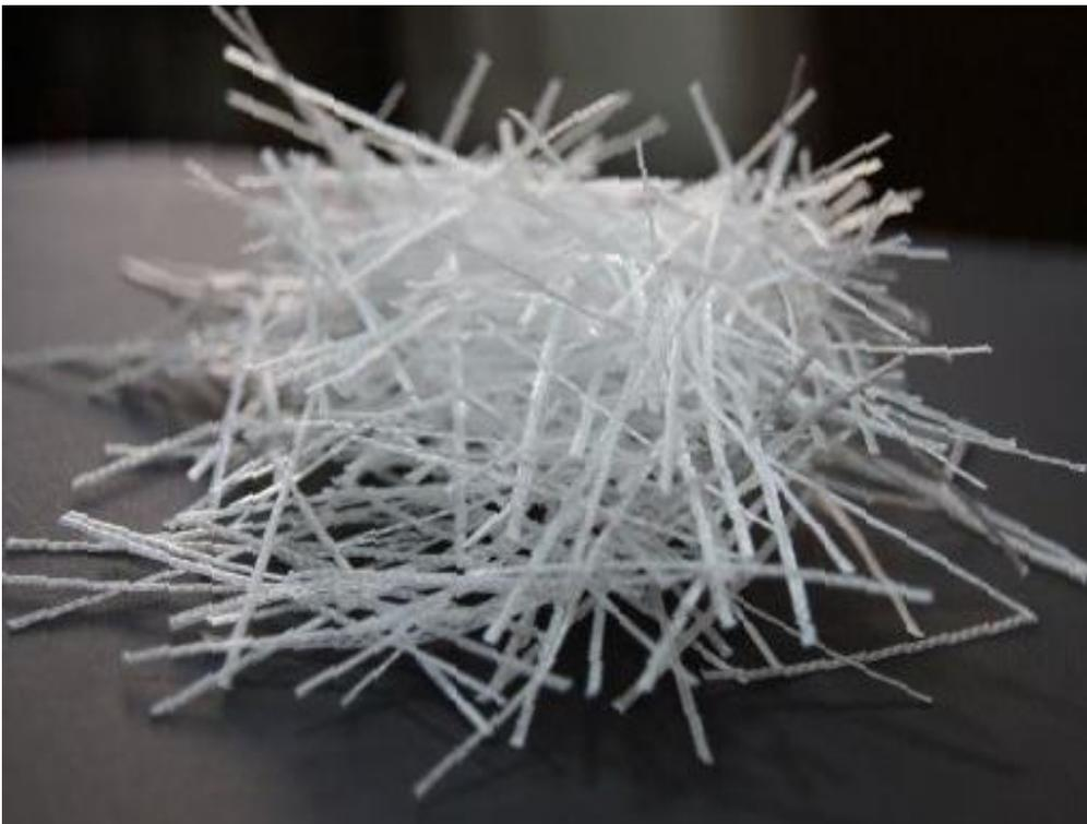
Рисунок 1.3 – Макросинтетическая фибра
