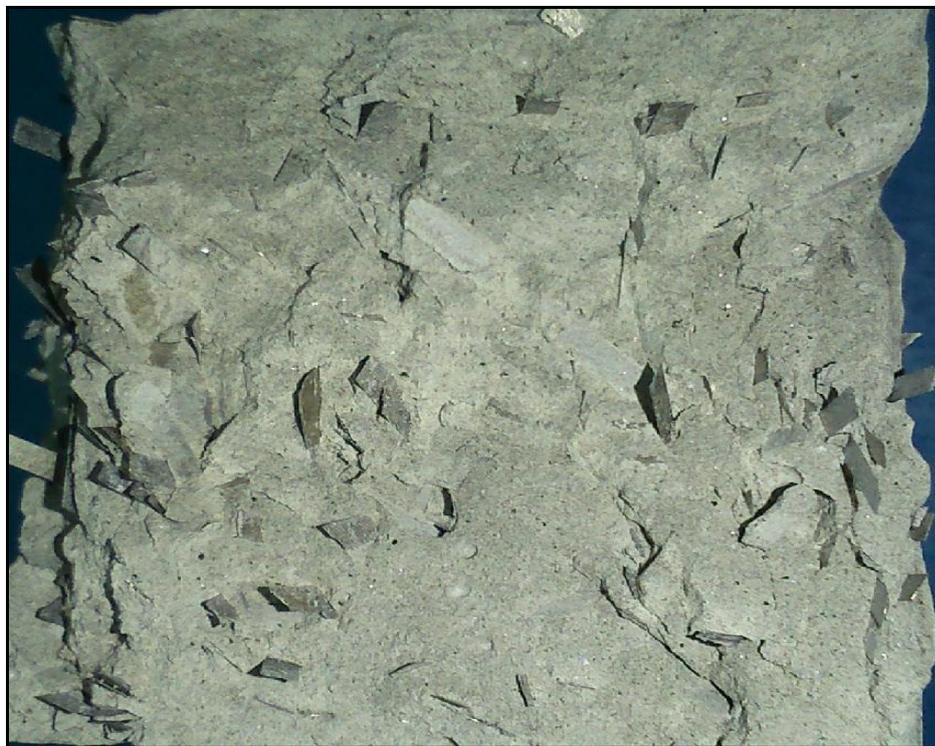
Рисунок 2.7 – Поверхность разрушенного фиброцементного образца, армированного аморфнометаллической фиброй
