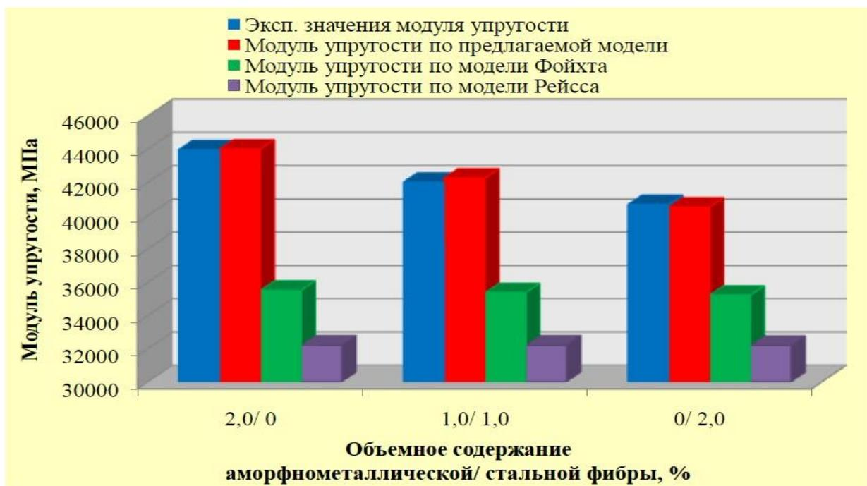
Рисунок 3.3 – Зависимость модуля упругости от соотношения аморфнометаллической и стальной фибры
