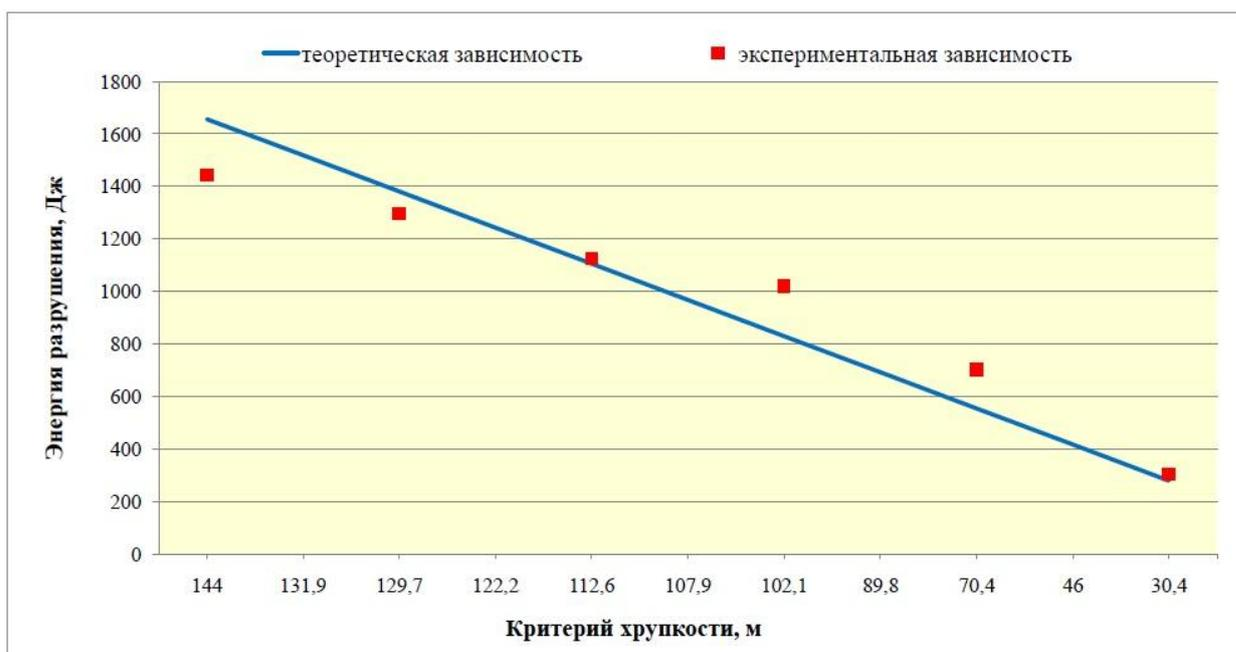
Рисунок 4.8 – Зависимость между критерием хрупкости и энергией разрушения
