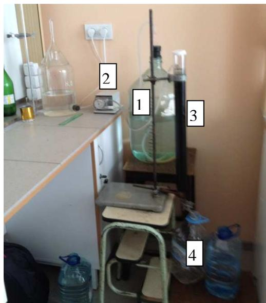
Рисунок 2 – Схема и вид опытной установки: 1 – резервуар (емкость) с модельным раствором; 2 – насос АНП-10М; 3 – фильтровальная колонка; 4 – сосуд для проб
