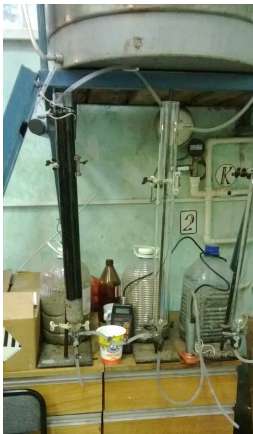
Рисунок 4. 1 Схема и внешний вид лабораторной установки: 1 – резервуар с дистиллированной водой; 2 – насос АНП-10М; 3 – фильтровальная колонка с КСЗ; 4 – точка ввода раствора хлорида; 5- кондуктометр портативный HANNA HI 8733; 6 – проточная колонка.
