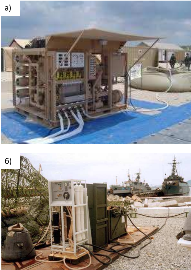
Рисунок 1.2. Конструкции полумобильных установок водоподготовки: а) установка водоподготовки 600 GPH ROWPU, производительность 2,7 м 3 /ч [94]; б) переносная водоочистная установка ПВУ300, производительность 300 л/ч [10]
