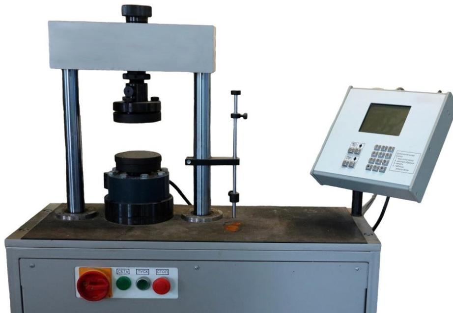
Рисунок 27 – Общий вид машины для испытаний асфальтобетонных образцов.
