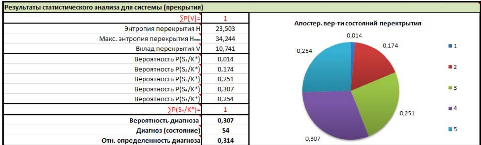
Рисунок В.31 – Результаты ВАТС для подсистемы «междуэтажное железобетонное перекрытие»
