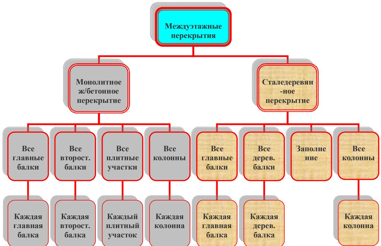
Рисунок 7.7 – Часть диагностического дерева (ветвь «междуэтажные перекрытия»)
