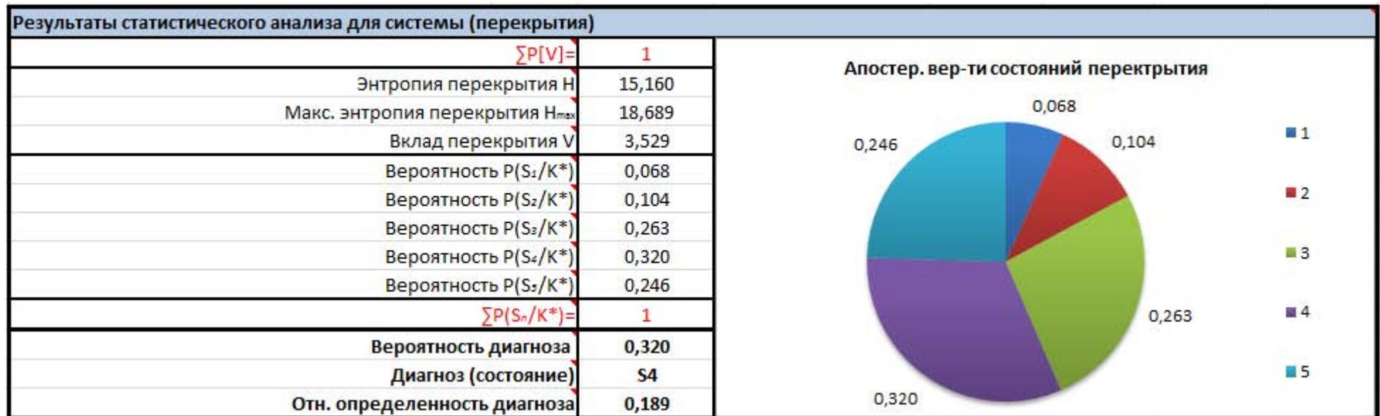
Рисунок В.41 – Результаты ВАТС для подсистемы «междуэтажное сталедревянного перекрытие»
