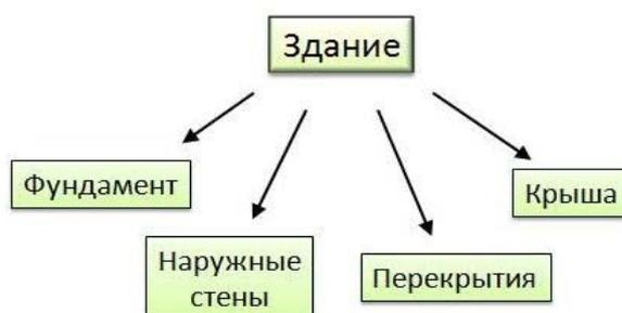
Рисунок Б.1 – Основные системы элементов здания
