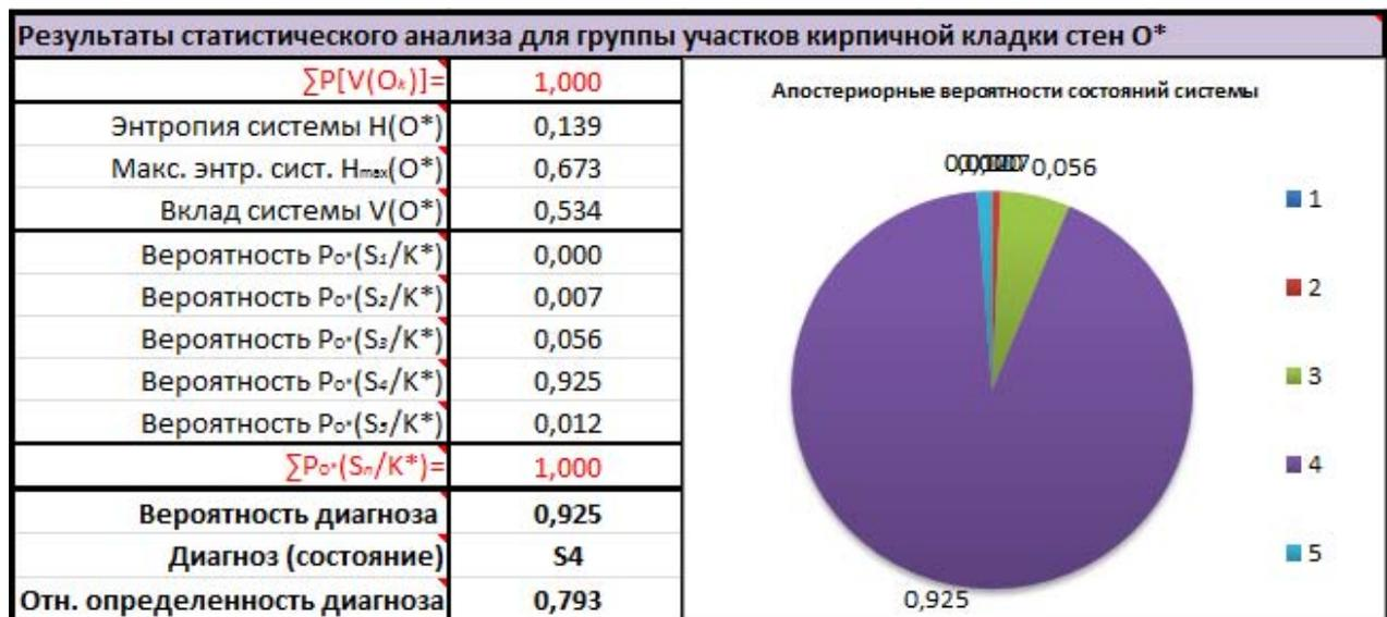
Рисунок В.16 – Результаты ВАТС для кирпичной кладки стены надподвального перекрытия
