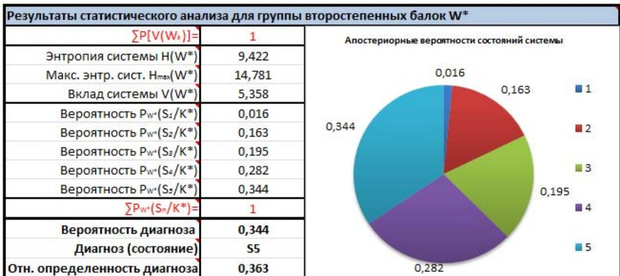
Рисунок В.24 – Результаты ВАТС для группы второстепенных балок междуэтажного железобетонного перекрытия
