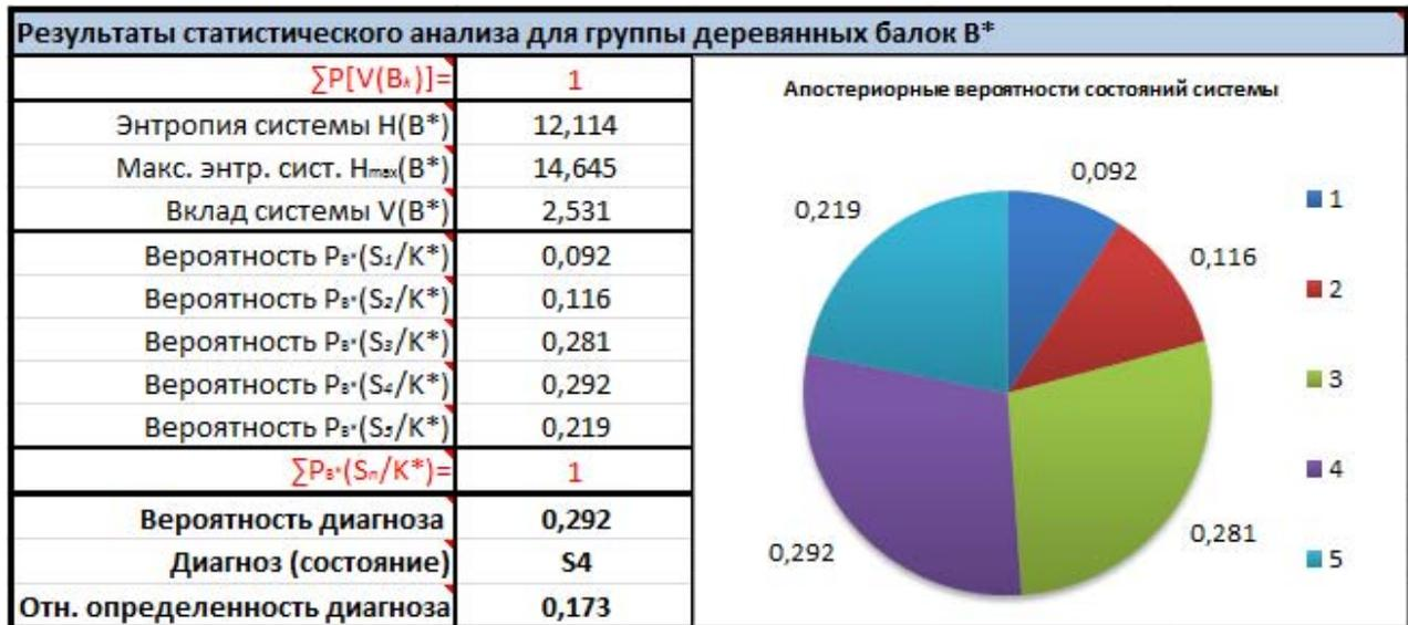
Рисунок В.37 – Результаты ВАТС для группы деревянных балок междуэтажного сталедеревянного перекрытия
