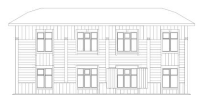
Рисунок Б.5 - Главный фасад жилого дома рабочих станции Абакан по ул. Вокзальная 16 (обмерный чертеж 2012 г.)
