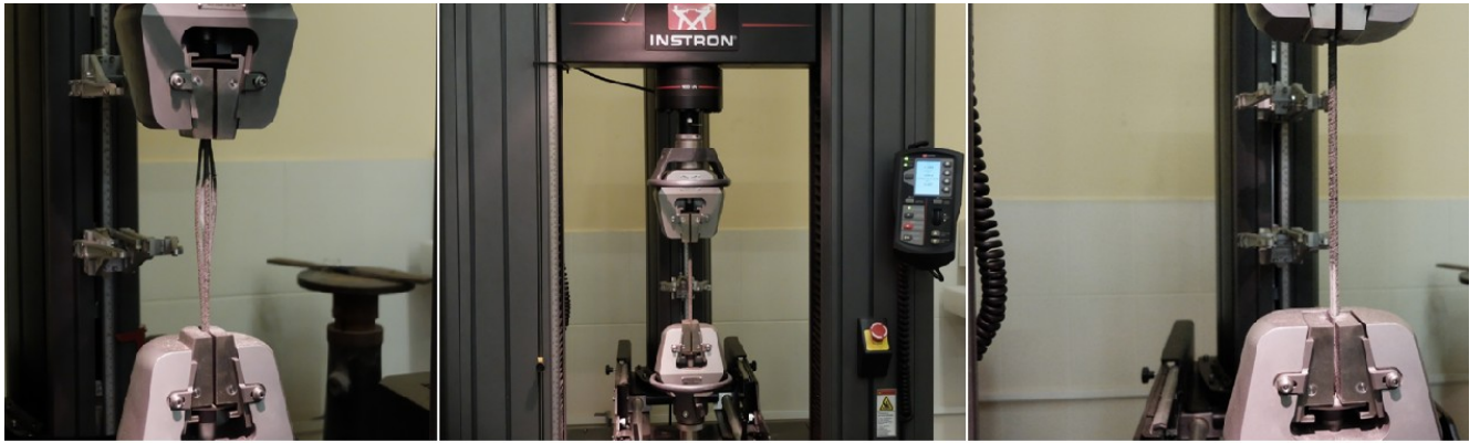
Рисунок 45 – Экспериментальная установка для испытаний базальтовой арматуры.
