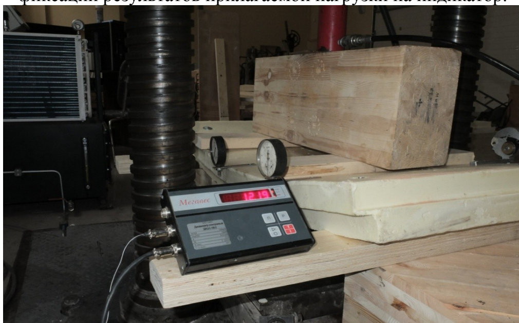
Рисунок 24 – Испытания пенополиуретановой панели без покрытия стеклотканью с фиксацией максимальной нагрузки.
