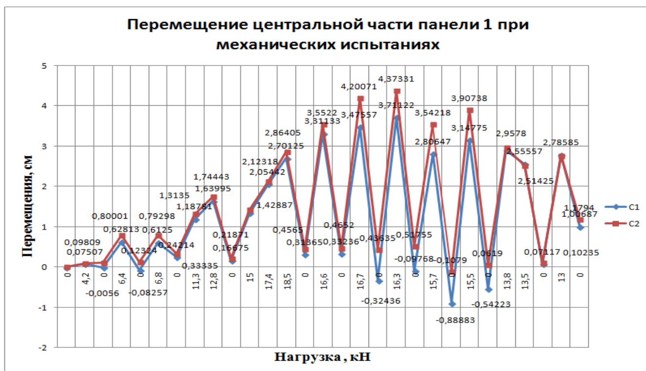
Рисунок 32 – Диаграмма зависимости перемещений центральной части «термопанели» №1 при циклических механических испытаниях от количества проведенных нагружений
