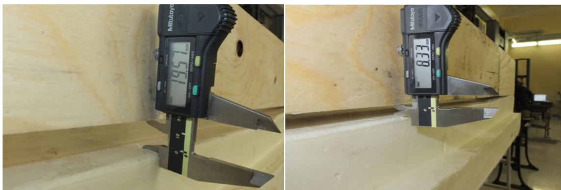
Рисунок 35– Остаточная деформация через месяц после снятия нагрузки с полиуретановой панели и через час – панели, имеющей внешнее покрытие и внутренний каркас
