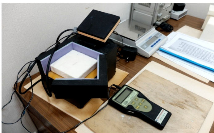
Рисунок 15 – Термоиспытания измерителем теплопроводности ИТП-МГЦ-250
