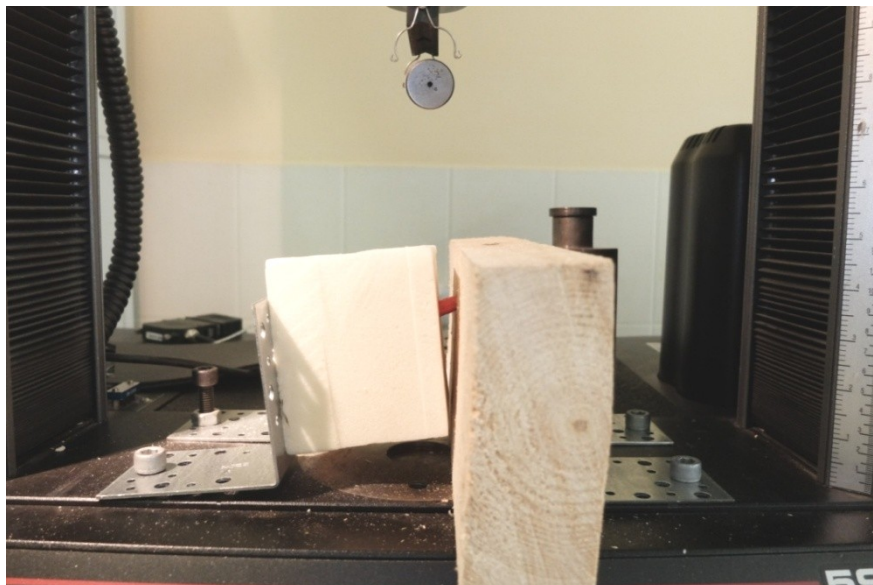
Рисунок 69 – Фиксация результата приложения срезающей нагрузки
