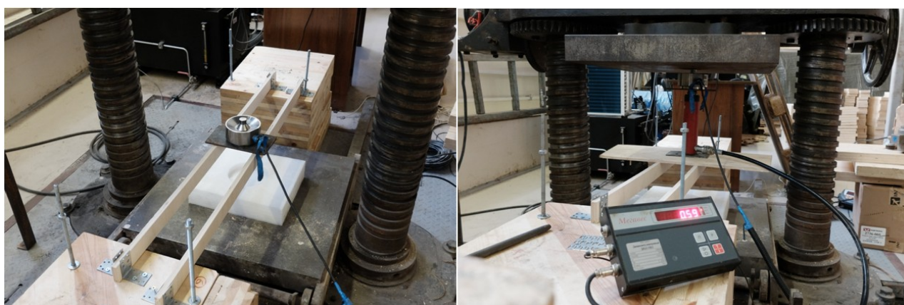
Рисунок 39 – Испытания фанерного каркаса на несущую способность.
