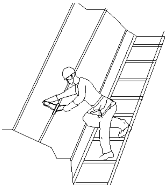
Рисунок 97 – Дозакрытие фальцевого соединения рамками второго прохода
