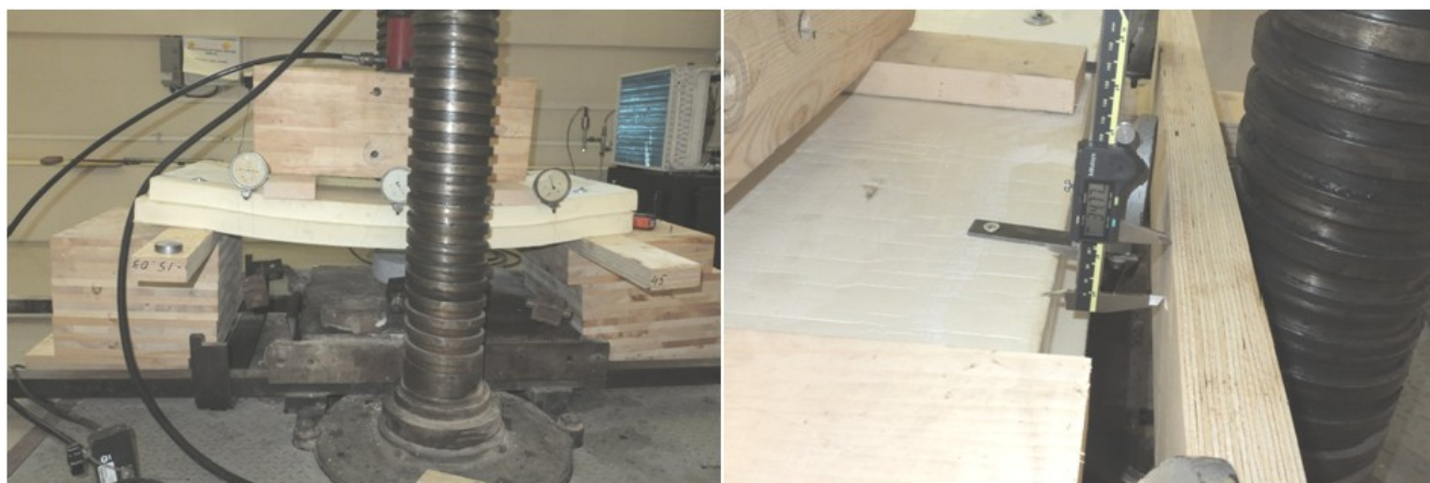
Рисунок 30 – Максимальный зафиксированный прогиб
