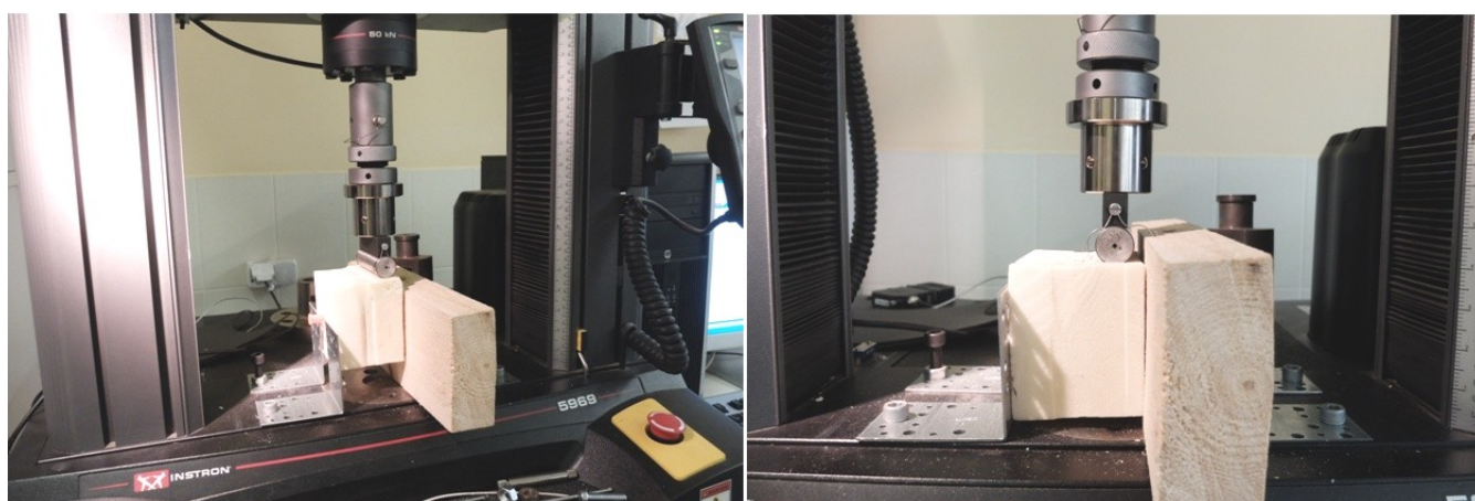
Рисунок 66 – Испытания дюбельного узла на срез
