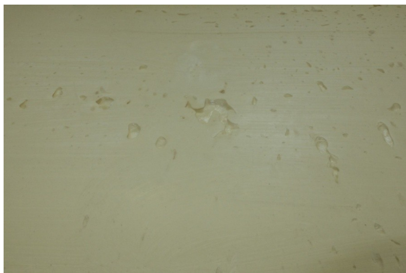
Рисунок 22 – Вид пенополиуретановой плиты без покрытия, с характерными образованиями раковин из-за отсутствия покрытия
