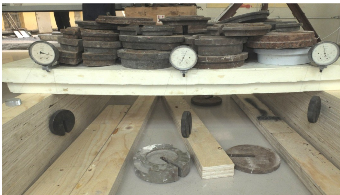
Рисунок 37 – Общий вид панели при ее испытании статической нагрузкой
