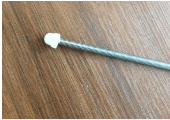
Рисунок 78 – Колпачковая полиамидная гайка со стальной шпилькой после проведения испытаний
