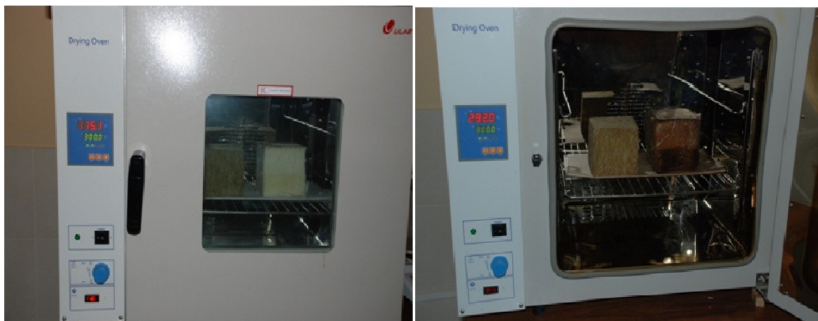
Рисунок 12 – Проведение сравнительных экспериментов на термоустойчивость пенополиуретана и каменной ваты
