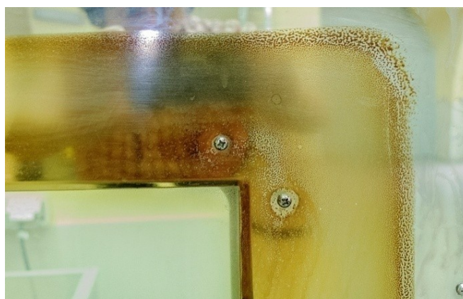
Рисунок 14 – Вид панели сушильного шкафа с характерным налетом, выделившимся при испытании на термостойкость смол
