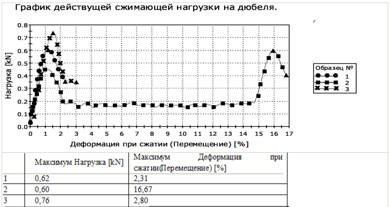
Рисунок 71 – График зависимости деформации от сжимающей нагрузки на дюбеля
