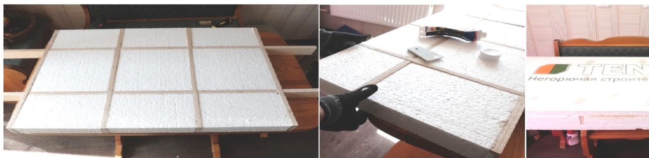
Рисунок 40 – Изготовление плит из пенополистирола
