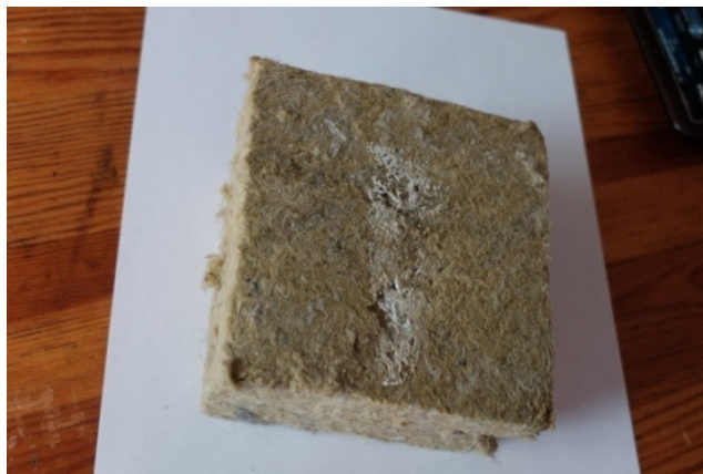
Рисунок 10 – Каменная вата через две недели просушки после проведения эксперимента на водопоглощение со следами плесени
