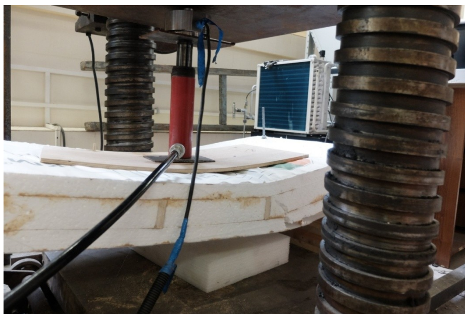
Рисунок 42 – Характерные признаки разрушения пенополистирольной плиты: трещины в каркасе, отслоение стеклоткани в верхней части плиты, и раскрытие трещин в нижней части плиты, удерживаемых от дальнейшего обрушения только стеклотканью
