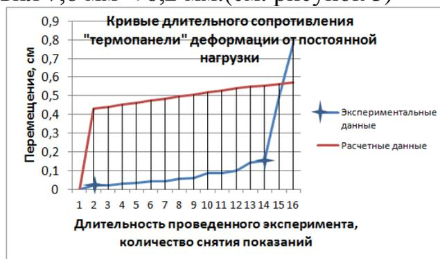
Рисунок 3 – Зависимость изменения длительного сопротивления «термопанели» при деформации от постоянной нагрузки
