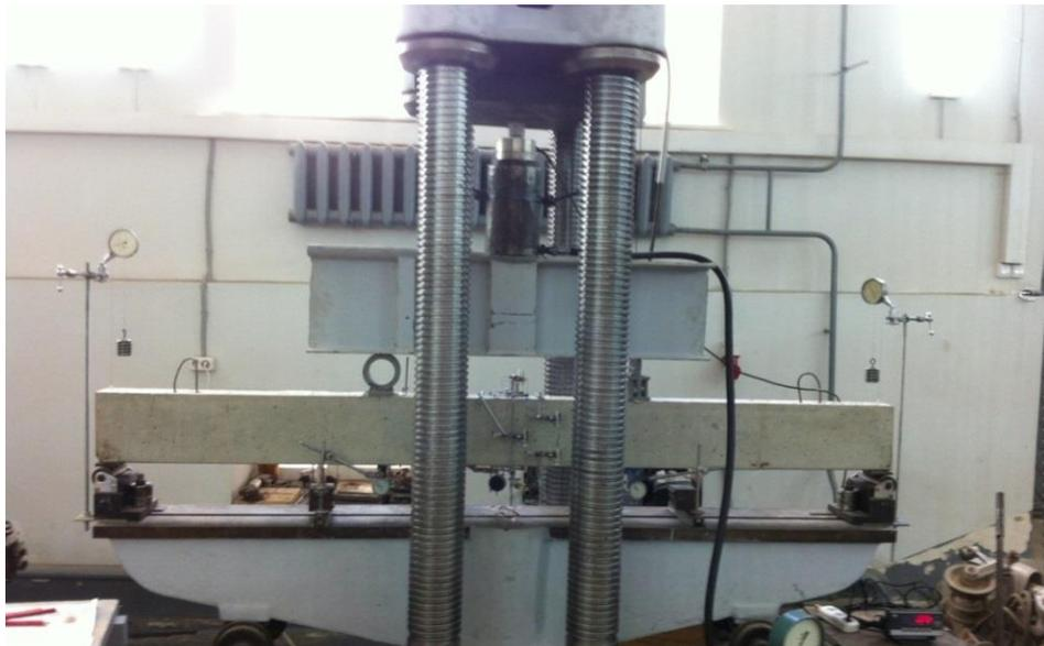
Рис. 4.24. Общий вид железобетонного образца на установке для испытания на изгиб
