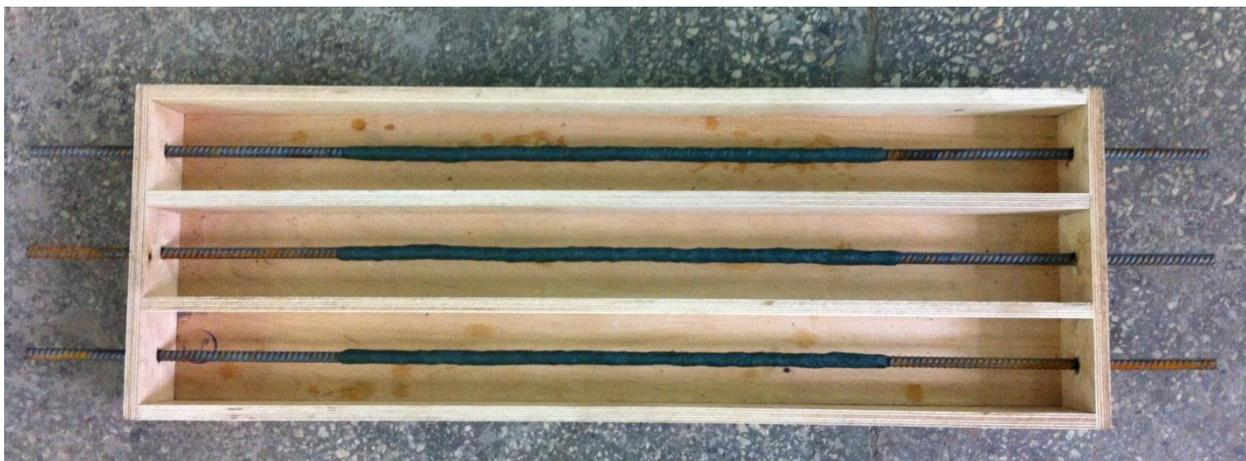
Рис. 4.5. Общий вид опалубки и армирования образцов для испытаний на центральное растяжение
