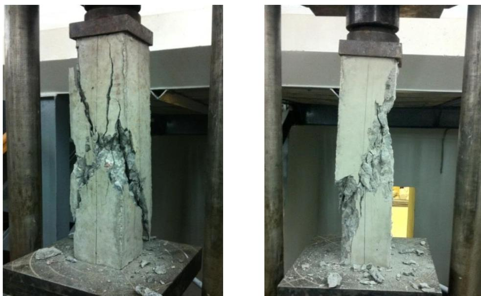
Рис. 4.9. Разрушение бетонных призм
