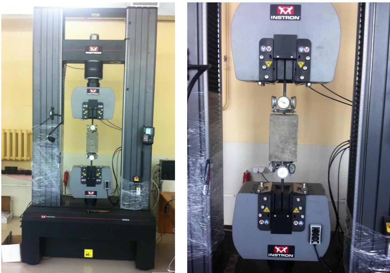
Рис. 4.11. Общий вид образца в испытательной системе INSTRON 5989
