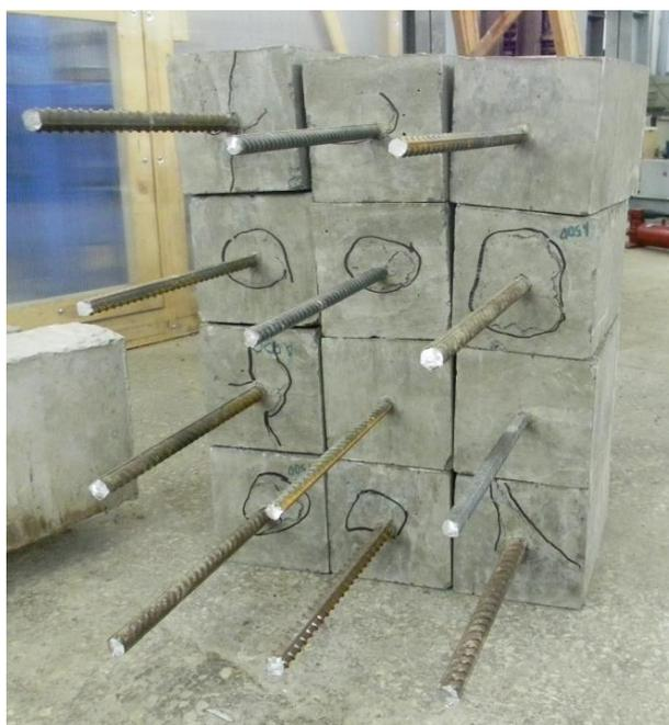
Рис. 4.14. Разрушение опытных образцов
