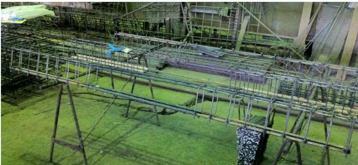
Рис. 4.2. Общий вид каркасов для экспериментальных образцов с нарушенным сцеплением
