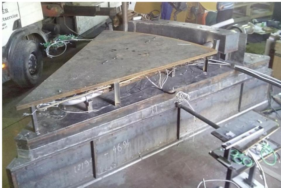
Рис. 4.2 Вид на полость после установки плиты днища без боковой опалубки
