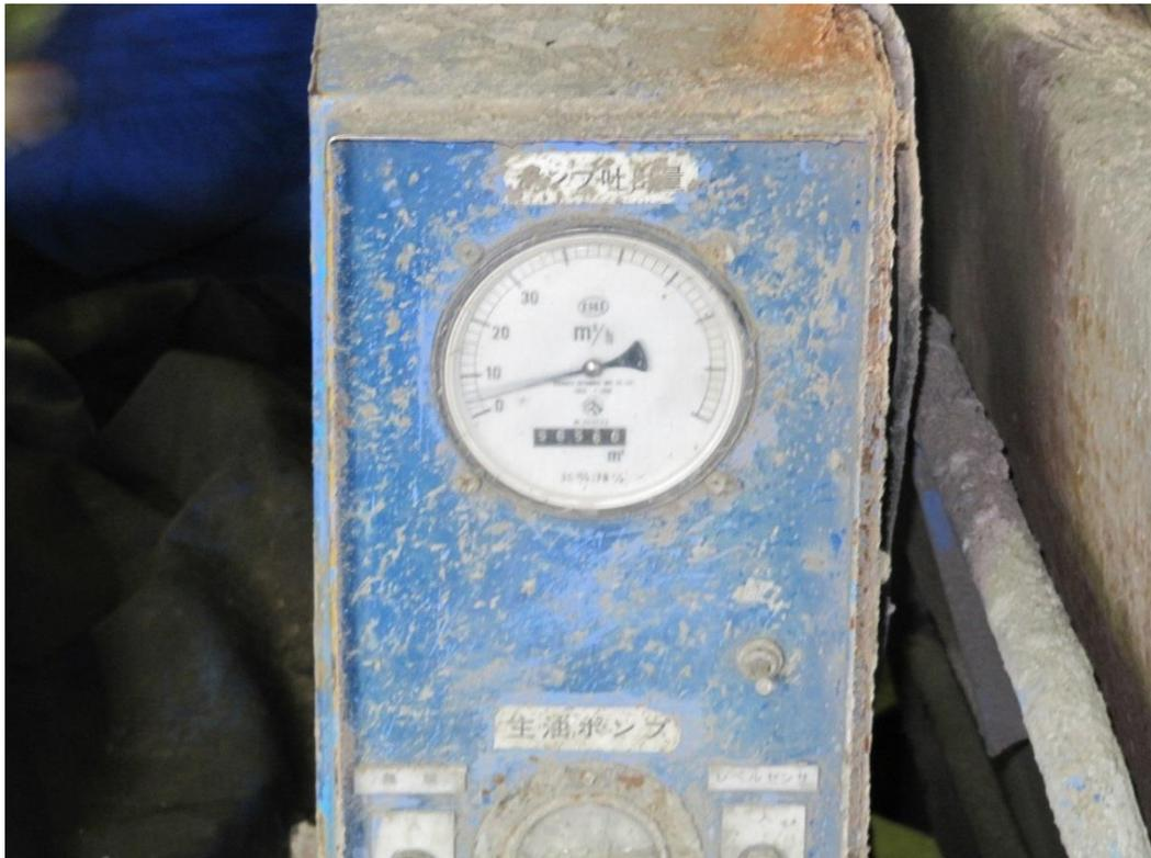
Рис. 4.7 Расходомер бетонной смеси
