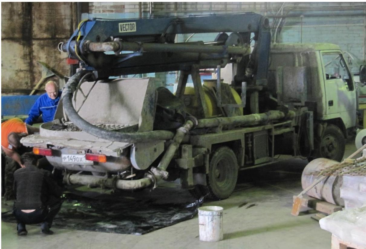
Рис.4.6 Бетононасос роторного типа
