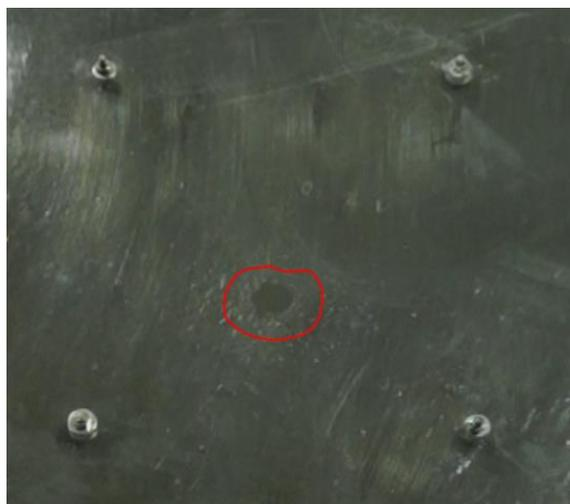
Рис. 3.15 Смачивание перекрытия в центре
