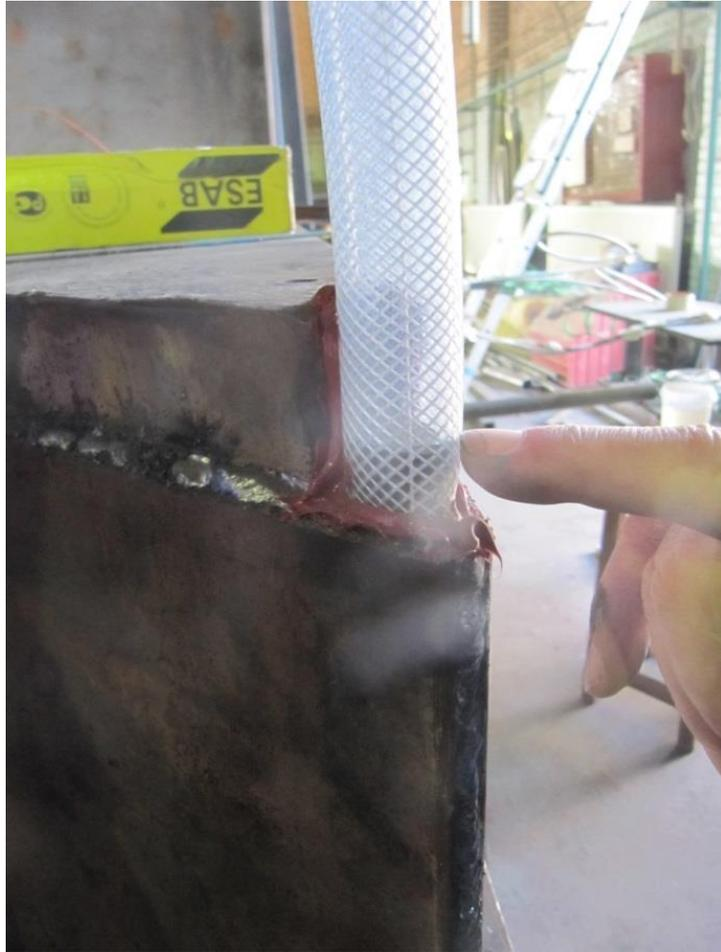
Рис. 4.13 Уровень бетонной смеси в полимерной прозрачной трубке
