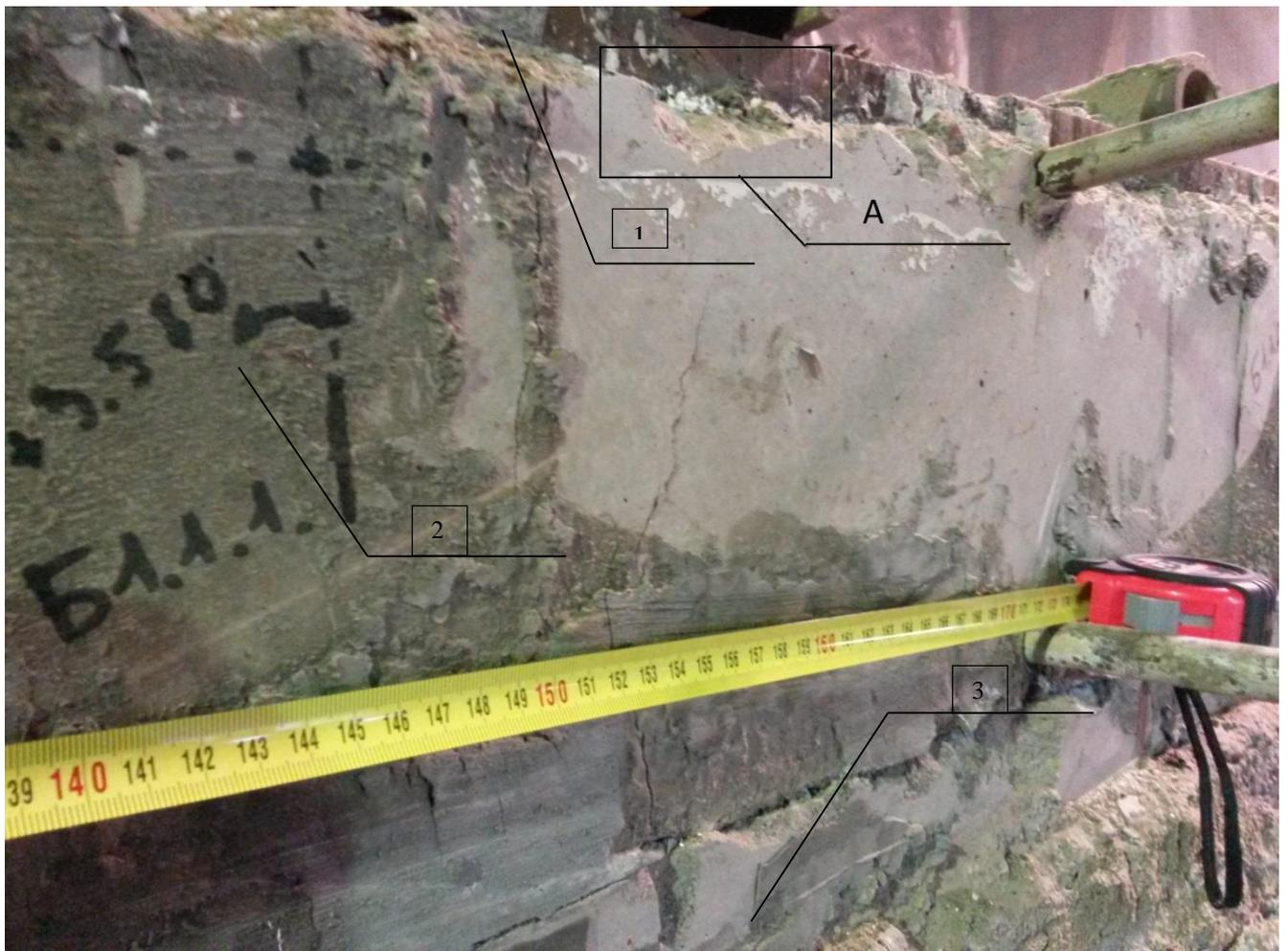
Рис. 4.15 Вид на стык бетона с днищем аппарата после демонтажа(демонтажа боковой металлической опалубки): 1. Корпус оборудования; 2. Бетон после тепловых испытаний; 3. Опорная плита
