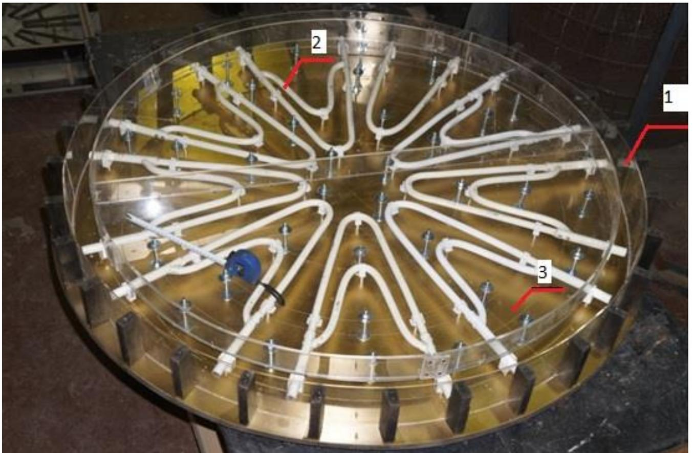
Рис.3.40 Масштабный макет: 1 – зазор между полостью и опалубкой(подпорная стенка); 2 – технологические включения; 3 – верхнее прозрачное перекрытие(днище оборудования)
