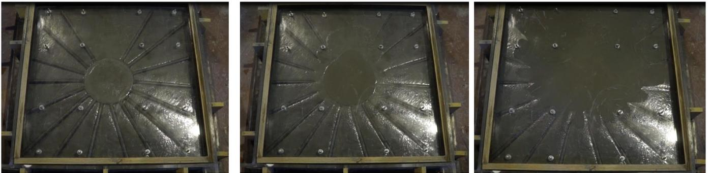
Рис. 3.20 Смачивание поверхности перекрытия
