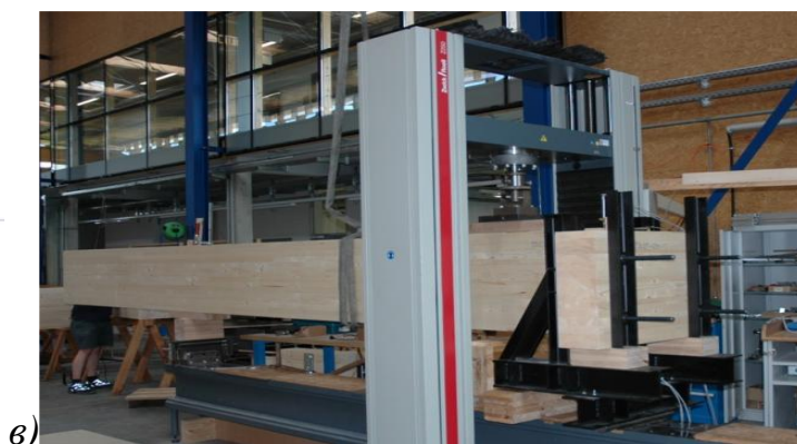
Рис. 1.14. Испытательная установка соединения на металлических накладках в деревянных конструкциях главной и второстепенной балки из клеённой древесины: а — установка опытных деревянных образцов ; б — установка измерительных инструментов; в — универсальная испытательная машина
