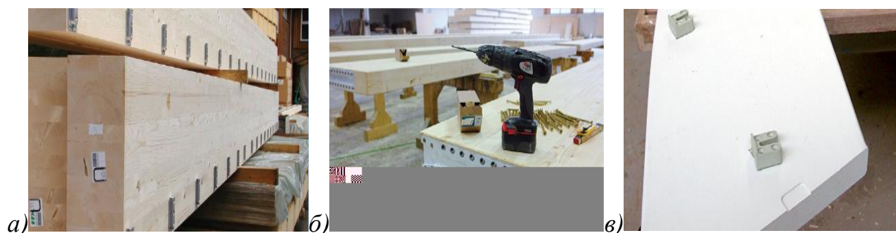
Рис. 1.3. Типы соединительных элементов типа SHERPA : а — линейка древесины; б — линейка XL ; в — линейка сборки
