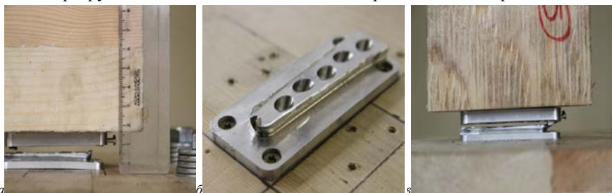
Рис. 8. Виды разрушения соединения на металлических накладках в деревянных конструкциях: а-б) – стеновой панели из CLT и балки из CLT; в) – стеновой панели из CLT и балки из LVL
