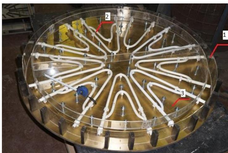
Рис. 6. Масштабный макет: 1 – зазор между полостью и опалубкой (подпорная стенка); 2 – технологические включения; 3 – верхнее прозрачное перекрытие(днище оборудования)
