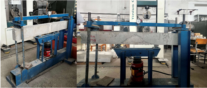
Рисунок 10 – Экспериментальная установка с образцами: с вертикальным швом (слева) и наклонным (справа)
