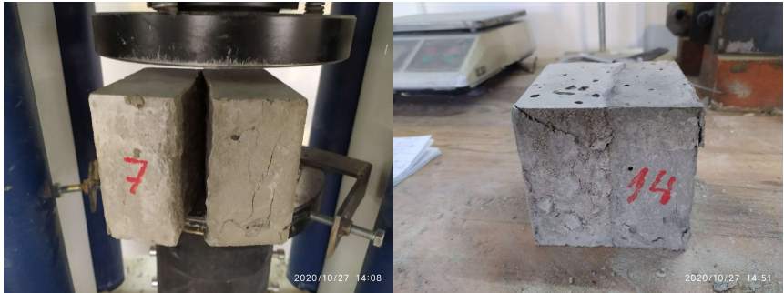
Рисунок 6 – Характер разрушения образцов при выдерживании по режиму 1/28: слева – разрушение образцов рН 7,1; справа – разрушение образцов рН 10,9 и 12,4
