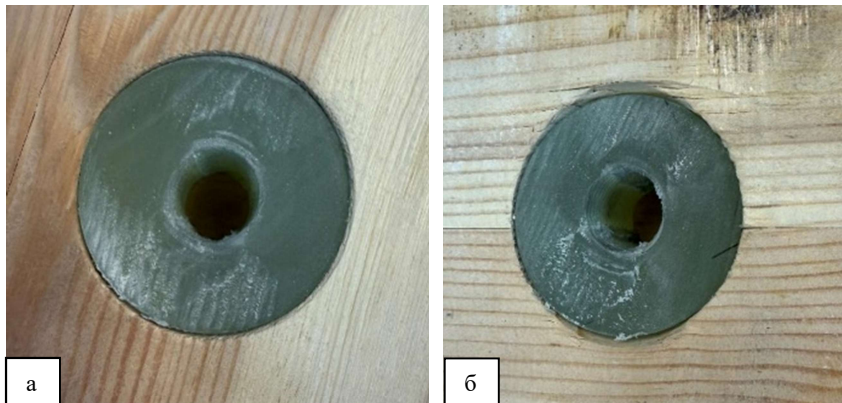
Рисунок 12 – Характер повреждения образцов из ДПК: а – остаточные деформации в полиуретановом вкладыше образца №4, б – пластические деформации в древесине под полиуретановым вкладышем при разрушении образца №3
