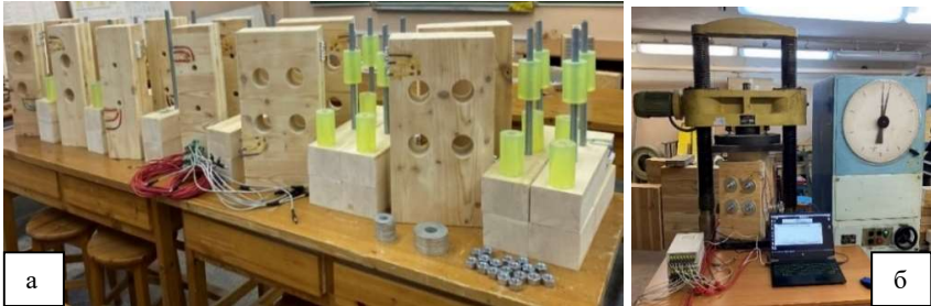
Рисунок 5 – Экспериментальное соединение: а – сборка образцов, б – испытания в прессе П125
