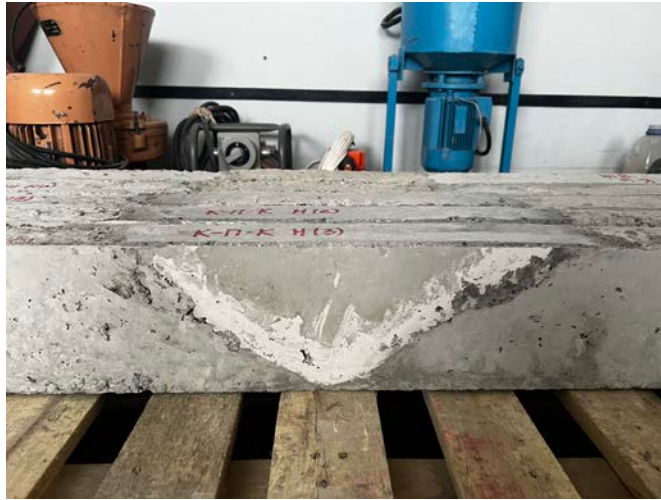
Рисунок 52 – Организация наклонных швов в образцах типа Т6
