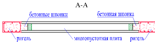
Рисунок 15 – Узел ригель-плита в системе АРКОС
