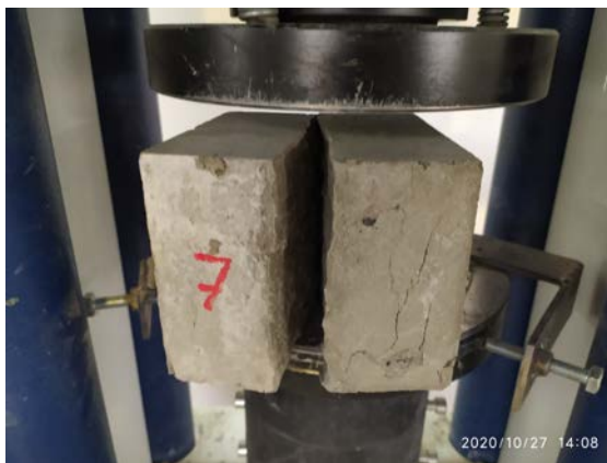
А – разрушение образцов с рН 7,1 по плоскости рабочего шва;
