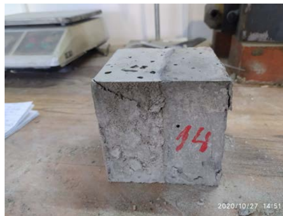
Б – разрушение образцов с рН 10,9 и 12,4 не по плоскости рабочего шва.
