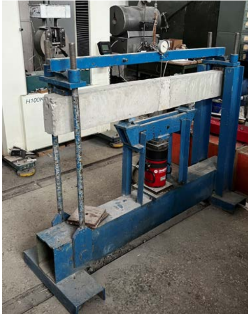
Рисунок 54, Рисунок 55 – Экспериментальная установка с образцами: с вертикальным швом и наклонным швом соответственно
