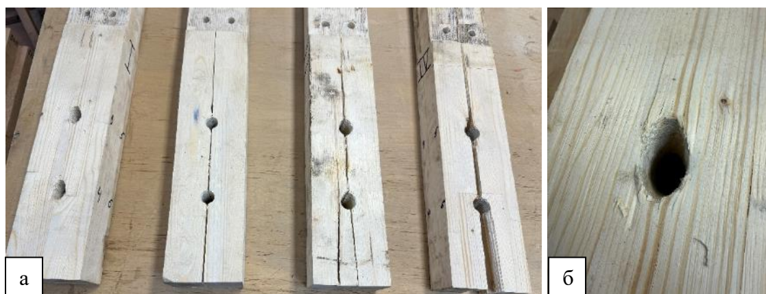
Рисунок 4.20 – Характер повреждения средних элементов образцов №№1-4: а – разрушение образцов №2,3,4 по среднему элементу, б – значительное обмятие нагельного гнезда среднего элемента образца №1
