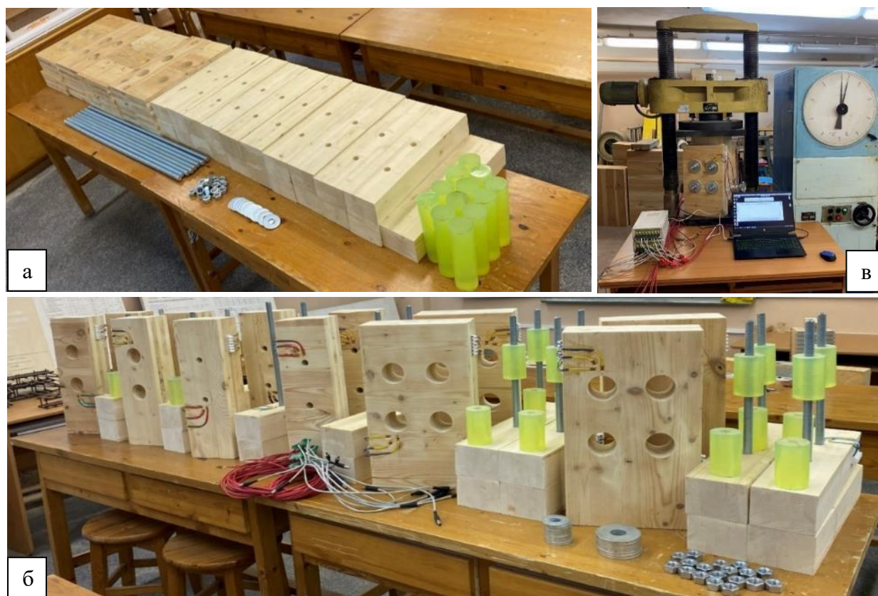
Рисунок 4.6 - Общий вид образцов на различных этапах подготовки к проведению эксперимента: а - общий вид заготовок ДКК и ДПК для сборки узлов; б - сборка экспериментальных образцов; в - общий вид расположения образца в прессе П-125 при статических испытаниях
