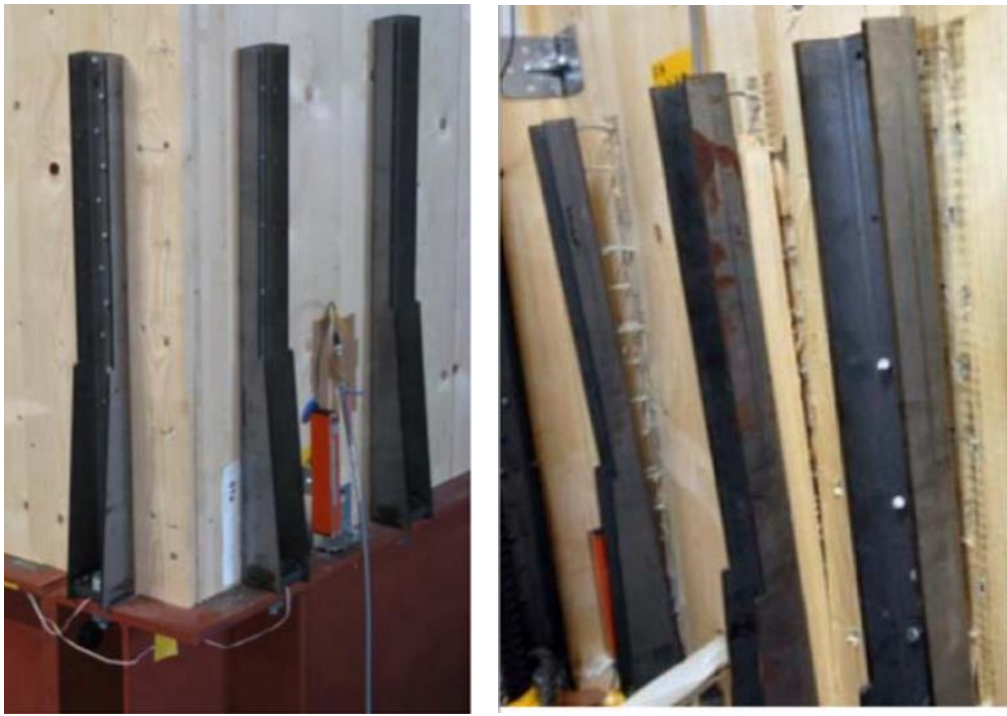
Рисунок 2.11 – Выдергивание гвоздей из вертикальных крепежных элементов [204]
