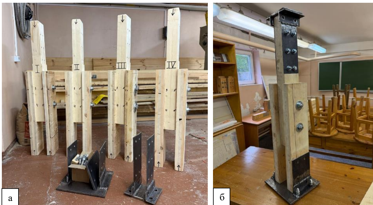
Рисунок 4.14 – Нагельные соединения клееных деревянных конструкций: а – экспериментальные образцы №1, 2, 3, 4 , б – образец 2 со смонтированной оснасткой
