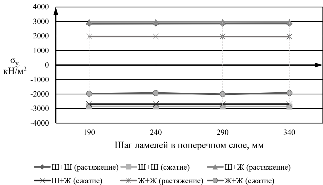
Рисунок 2.7 – Зависимость растягивающих и сжимающих нормальных напряжений \sigma_y от шага ламелей в поперечном слое трехслойной плиты перекрытия из ДПК при различных условиях опирания
