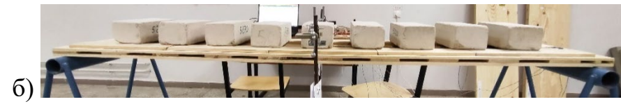
Рисунок 4.5 – Нагружение конфигурации № 3 (а – 1 ступень; б – 2 ступень; в – 3 ступень; г – 4 ступень)
