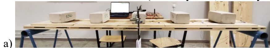
Рисунок 4.5 – Нагружение конфигурации № 3 (а – 1 ступень; б – 2 ступень; в – 3 ступень; г – 4 ступень)
