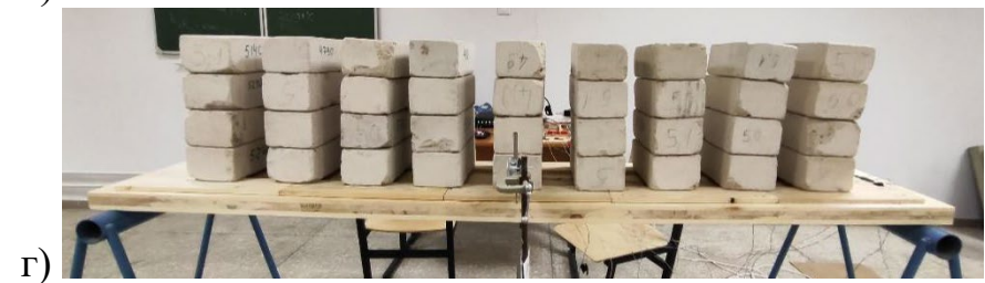
Рисунок 4.5 – Нагружение конфигурации № 3 (а – 1 ступень; б – 2 ступень; в – 3 ступень; г – 4 ступень)
