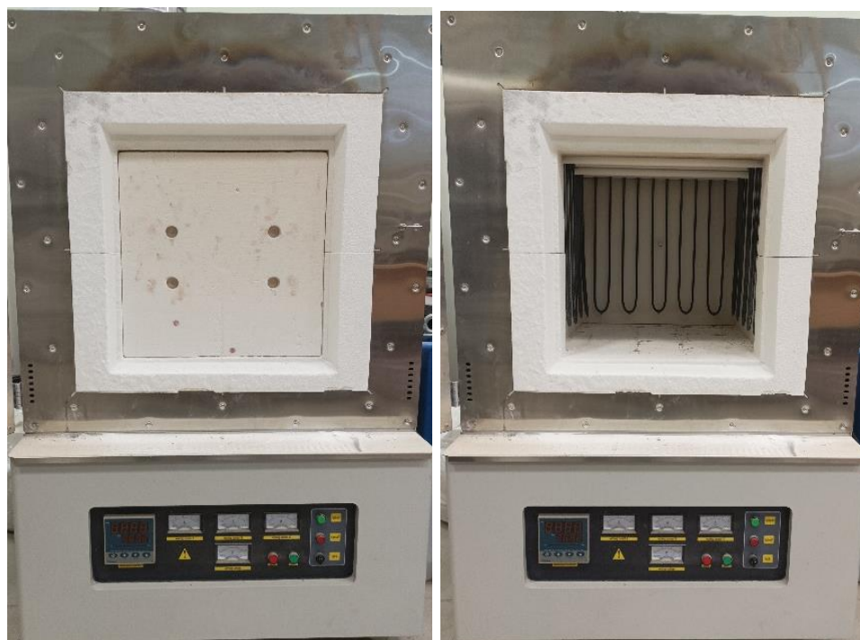
Рисунок А.9 – Общий вид муфельной печи ПМ-1700
