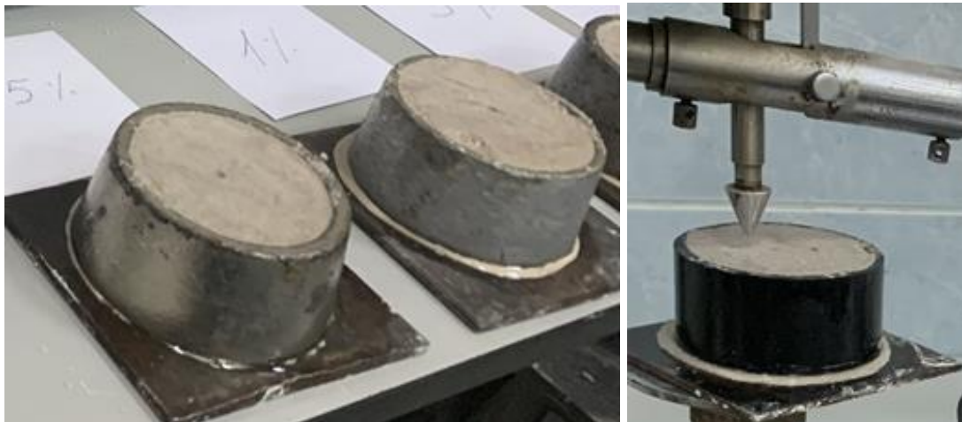
Рисунок 59 – Определение пластической прочности коническим пластометром Ребиндера
