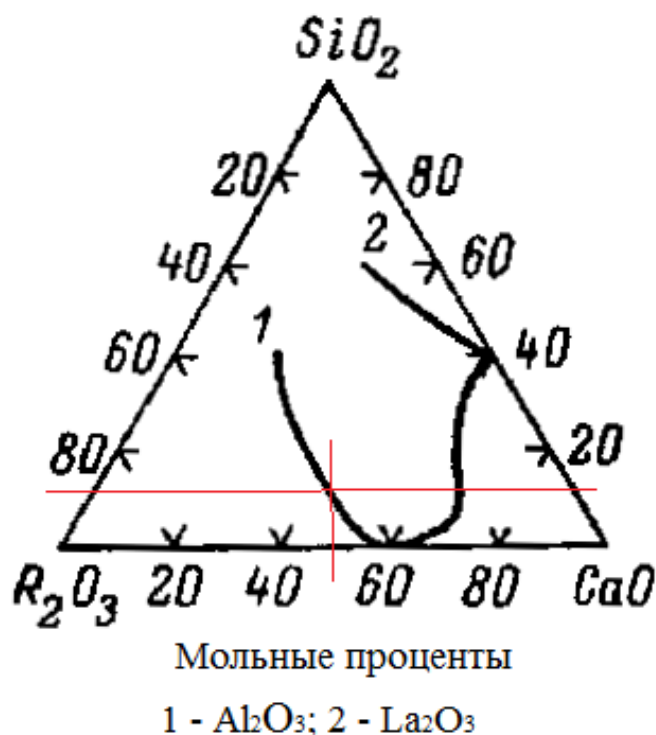
Рисунок 34 – Области стеклообразования в системе \text{CaO-R}_2\text{O}_3\text{-SiO}_2
