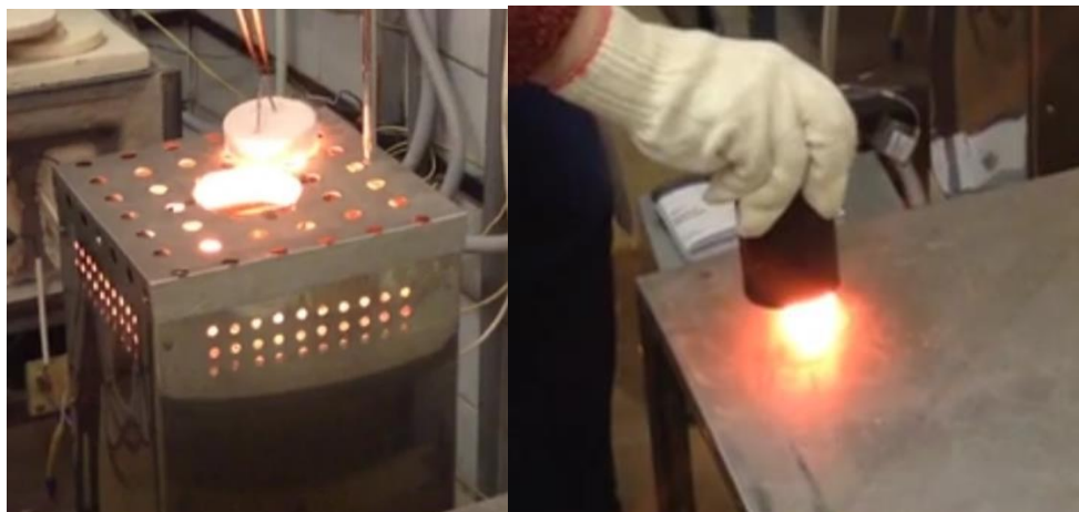
Рисунок 35 – Общий вид трубной печи. Процесс охлаждения расплава.
