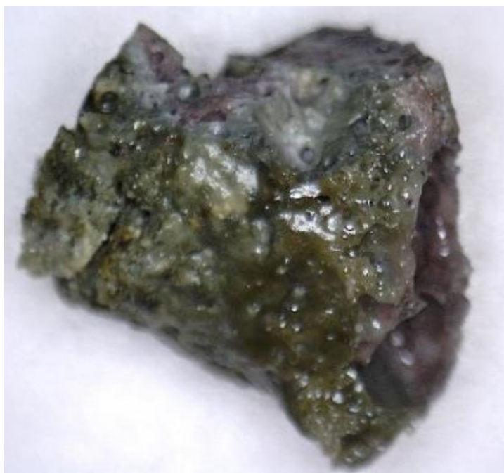
Рисунок 21 – Общий вид образца после термообработки. Температура обработки 1300°C
