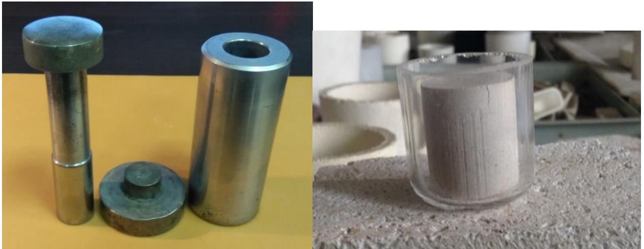
Рисунок 19 – Общий вид пресс-формы. Образцы цилиндры
