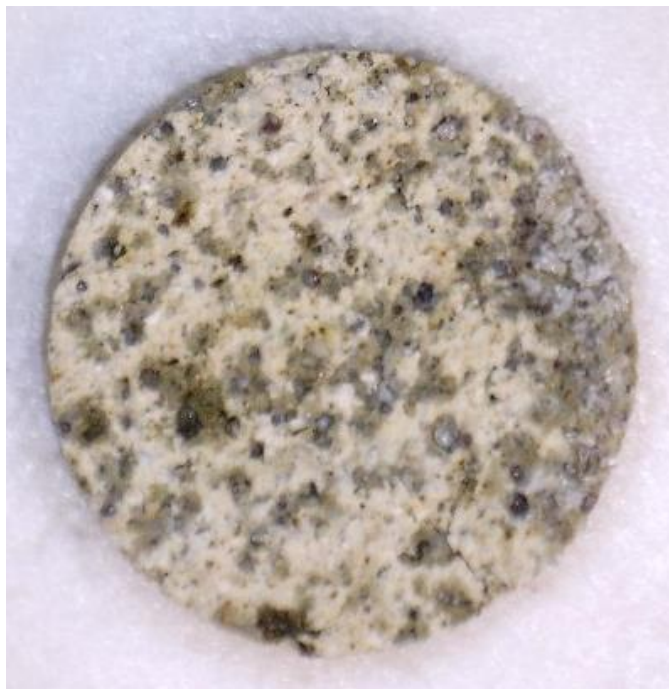
Рисунок 20 – Общий вид образца после термообработки. Температура обработки 1200°C
