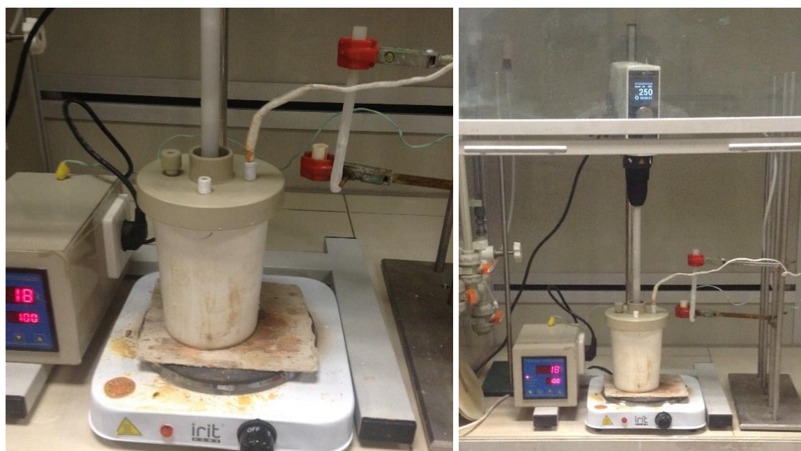
Рисунок 50 Общий вид лабораторной установки для выщелачивания шлака
