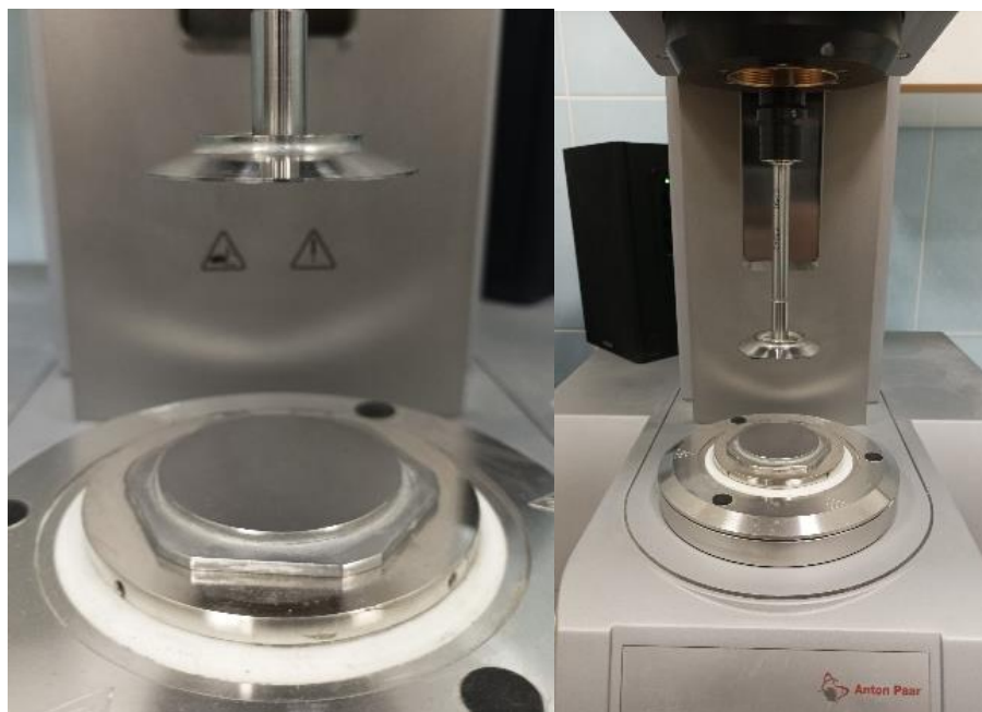
Рисунок 55 – Рабочий орган прибора реометра Physica MCR 102, Anton Paar, тип «плоскость – плоскость»
