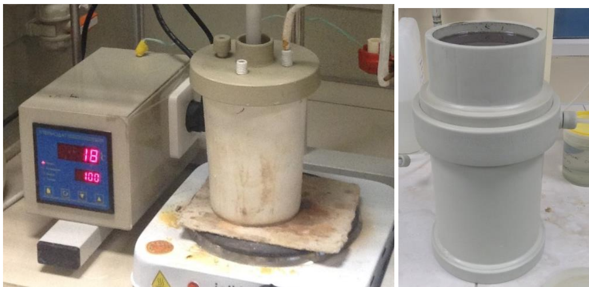
Рисунок 44 – Лабораторный реактор для выщелачивания шлака. Вакуумная фильтровальная станция
