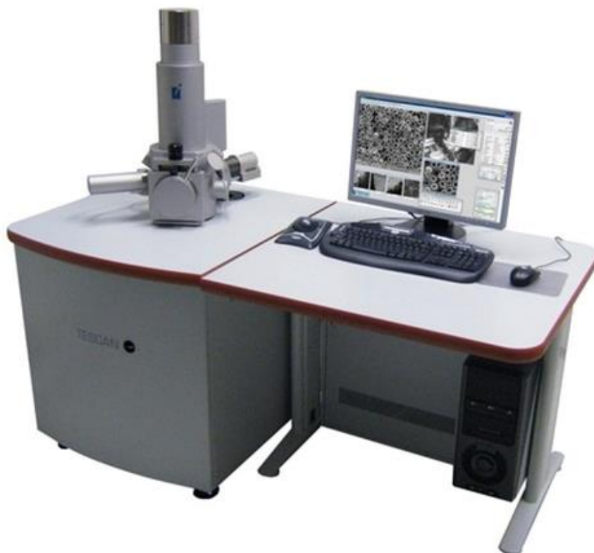
Рисунок А.3 – Общий вид электронного микроскопа Tescan VEGA 3 SBH
