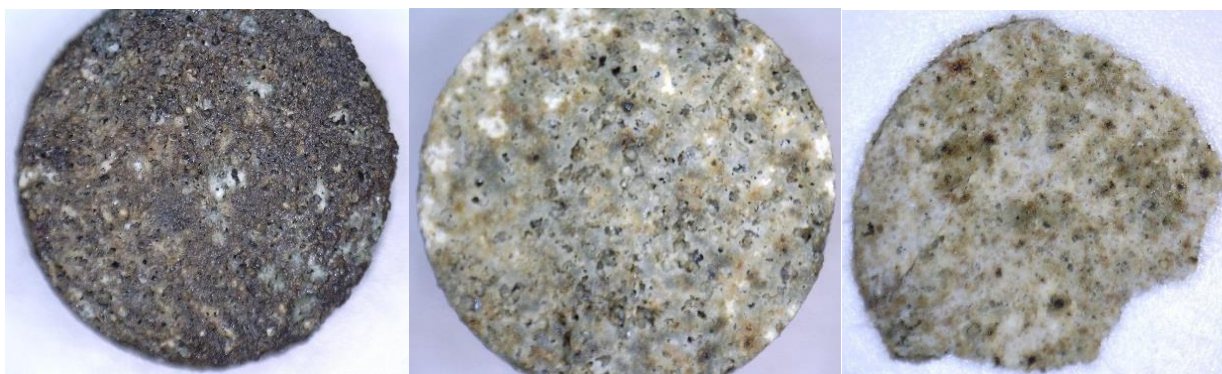
Рисунок 30 – Общий вид образцов спёков состава шлак/известь, % 50/50, 48/52 44/56
