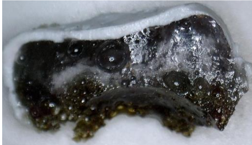
Рисунок 23 – Общий вид образца после термообработки. Температура обработки 1500°C
