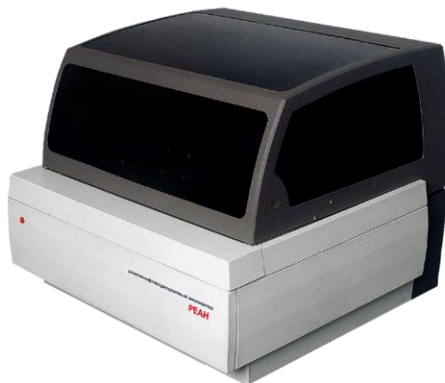
Рисунок 1.1 – рентгенофлуоресцентный энергодисперсионный спектрометр «РЕАН»
