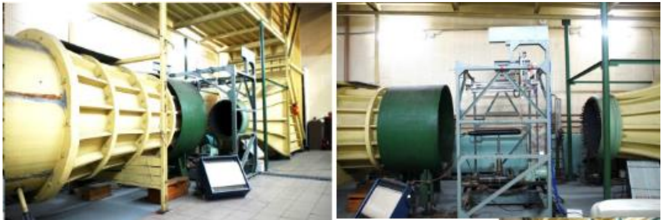
Рисунок 3.4 – Общий вид гидродинамической установки-аэродинамической трубы (а) и ее рабочей зоны с монтажно-измерительным комплектом (б)
