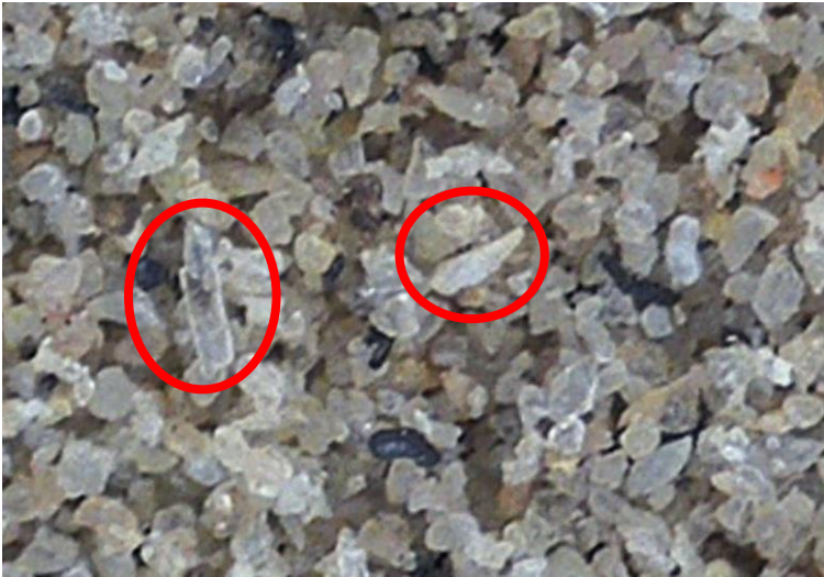
Рис. 2. Пылеватый песок, загрязненный дизельным топливом. Образование агрегатов
