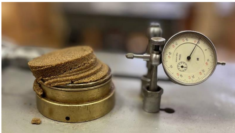
Рис. 4. Образец песчаного грунта, загрязненного дизельным топливом, после проведения испытания на одноплоскостной срез
