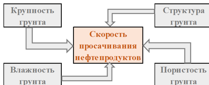
Рисунок 1.9. Факторы, влияющие на скорость просачивания (инфильтрации) нефтепродуктов в песчаные грунты [68]
