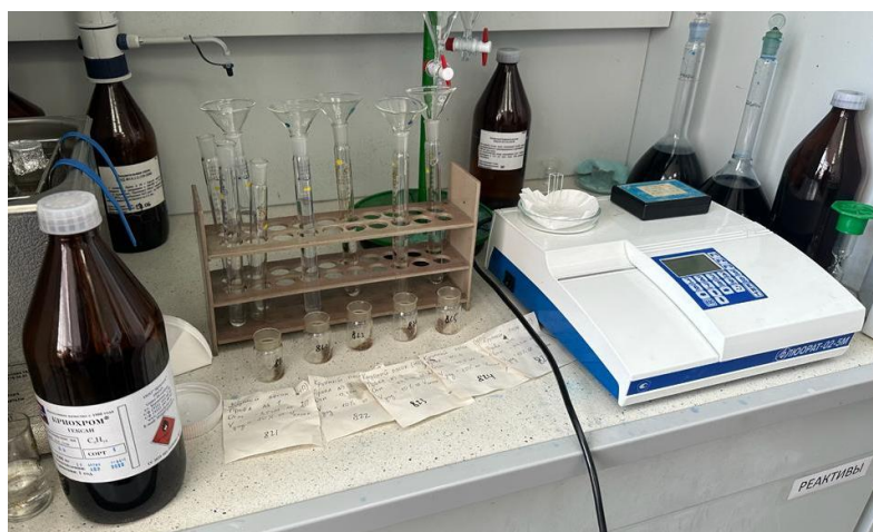
Рисунок 2.19. Прибор «Флюорат-2» модификации «Флюорат-02-5М»: а) прибор «Флюорат-2»; б) – подготовка к проведению лабораторных исследований.
