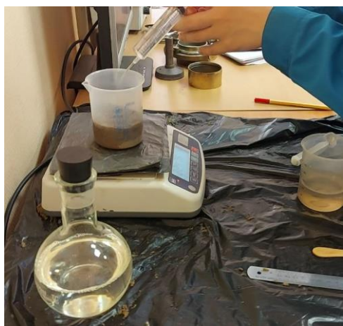
Рисунок 3.3. Процесс подготовки песчаного образца, загрязненного дизельным топливом: а) – затворение нефтепродуктом; б) – подготовка образца к испытанию.
