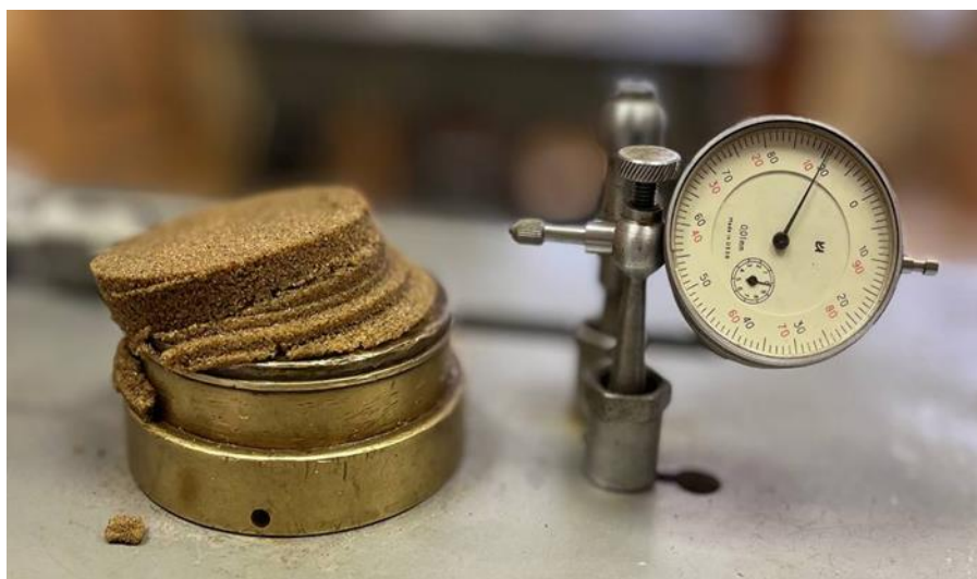
Рисунок 3.1. Образец песчаного грунта, загрязненного дизельным топливом, после проведения испытания на одноплоскостной срез
