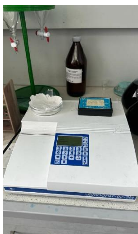
Рисунок 2.19. Прибор «Флюорат-2» модификации «Флюорат-02-5М»: а) прибор «Флюорат-2»; б) – подготовка к проведению лабораторных исследований.
