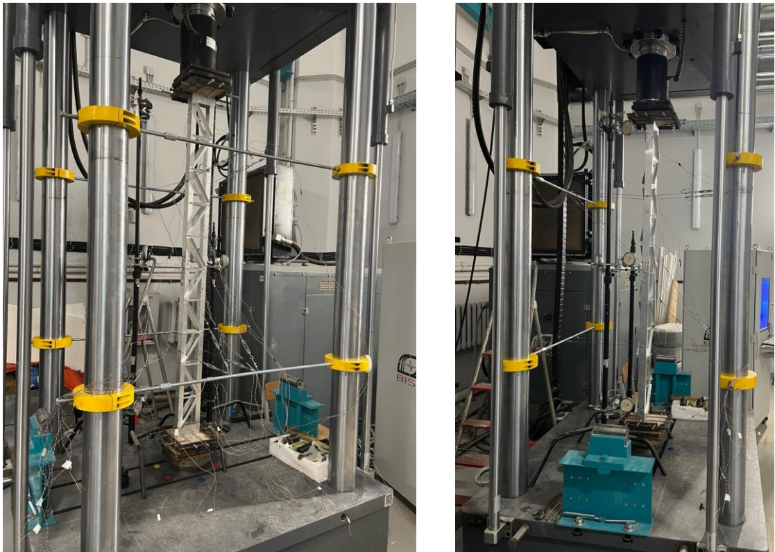
Рисунок 5.6 Готовый образец для испытаний в испытательной машине Instron 1000kN
