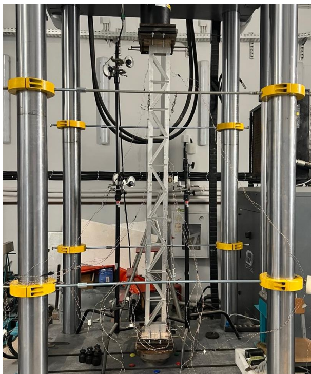
Рисунок 5.1 Установленный образец в испытательной машине
