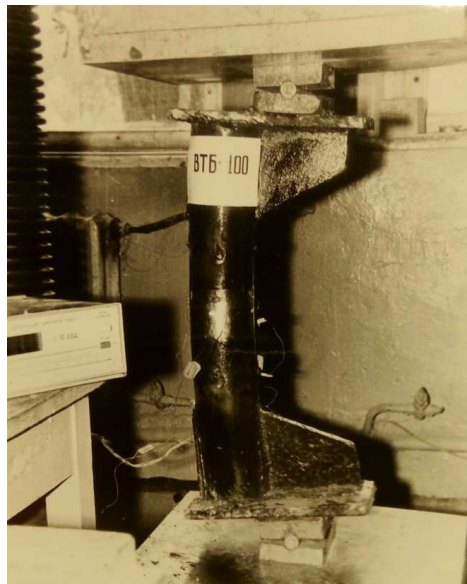
Рис. 4.3 - Испытания коротких трубобетонных стержней В.В. Пинским [ ]
