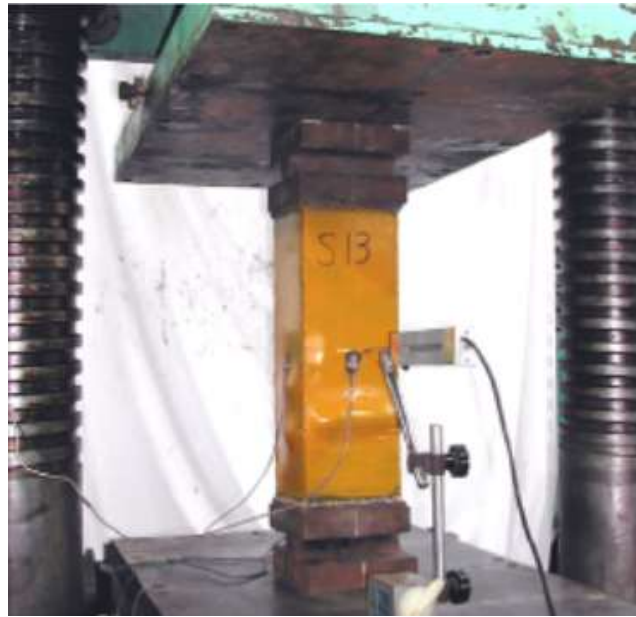
Рис. 4.1 – Испытания коротких трубобетонных стержней D. Liu
