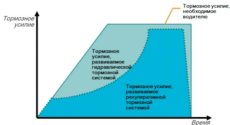
Рисунок 2.45 – График совмещения тормозного усилия между электродинамической и механической тормозной системой
