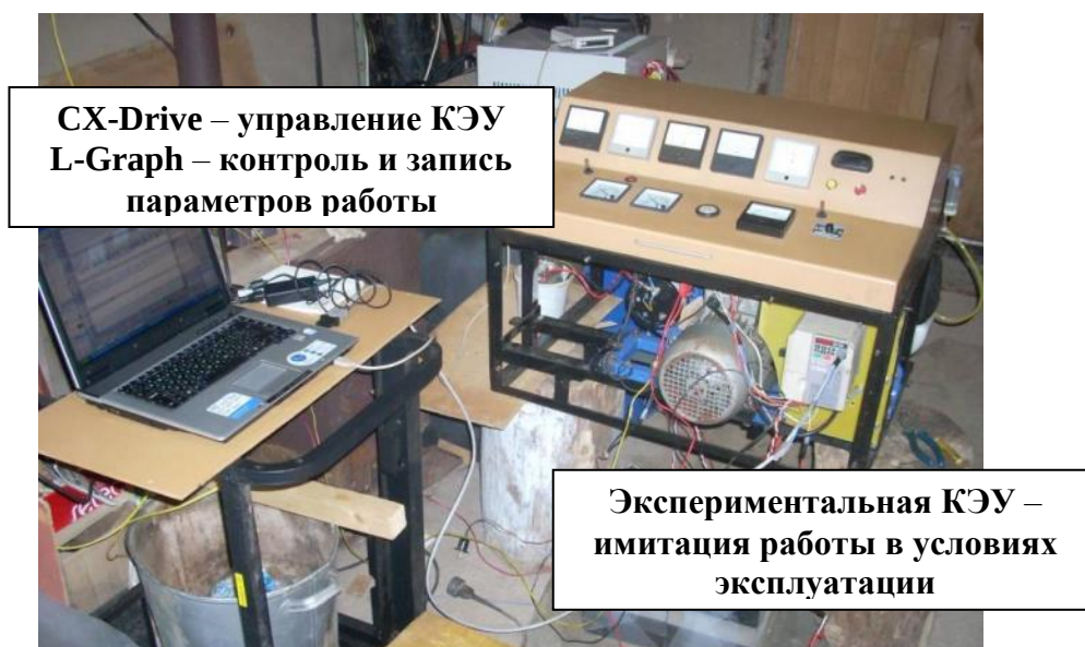
Рисунок 2.18 – КЭУ при проведении экспериментальных исследований
