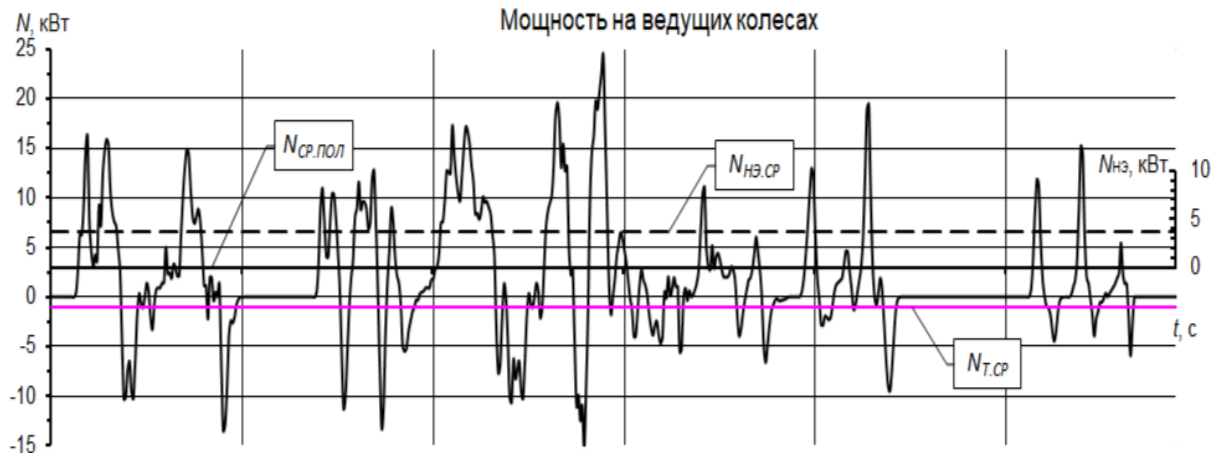
Рисунок 3.9 – Изменения мощности силы тяги на ведущих колесах автомобиля
