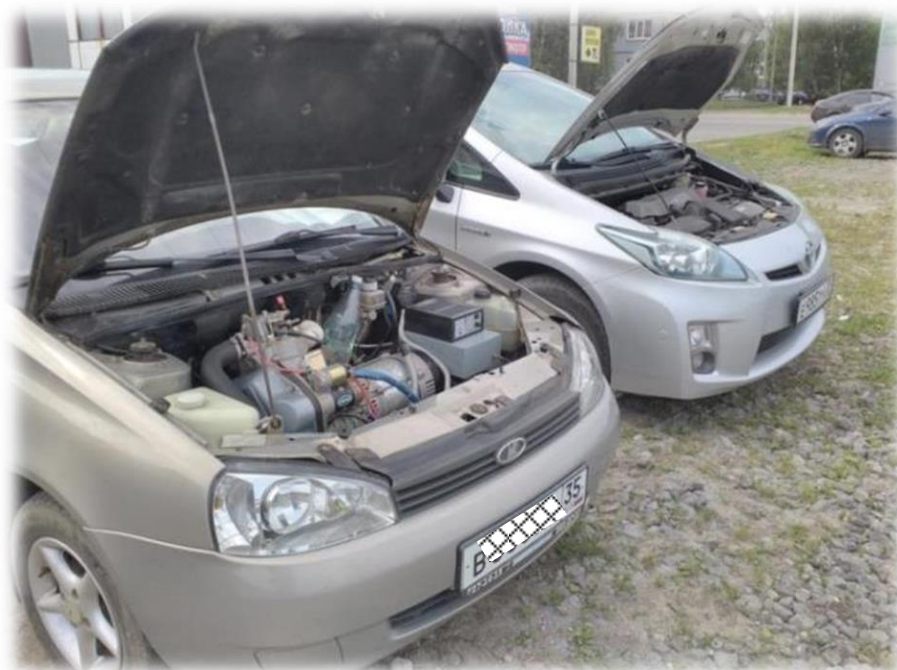
Рисунок 2.32 – Экспериментальные автомобили с КЭУ (слева на базе Lada 1118 Kalina, справа на базе Toyota Prius ZVW30)
