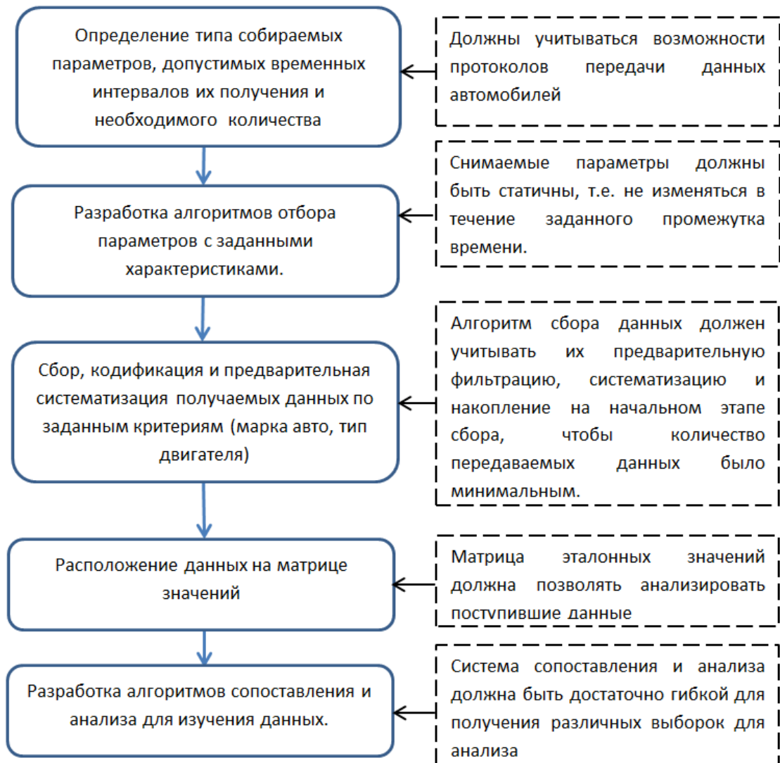
Рисунок 2.8 – Порядок получения эталонных значений параметров рабочих процессов двигателя
