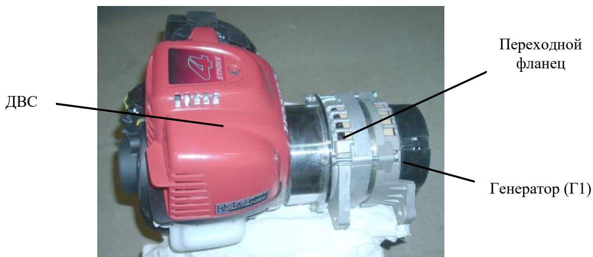
Рисунок 2.13 – Генераторная установка экспериментальной КЭУ
