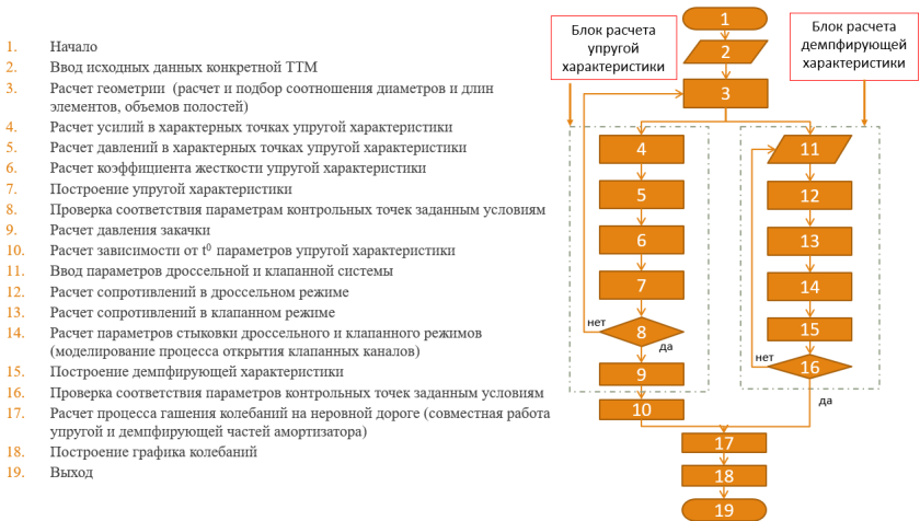
Рис. 8. Алгоритм расчета параметров гидропневматического амортизатора на ЭВМ
